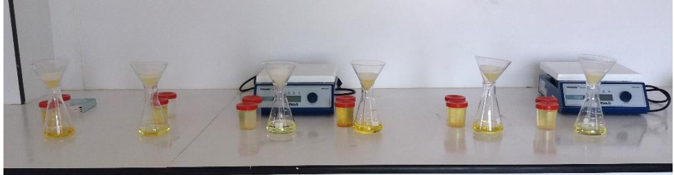
Şekil 3.12. Biyodizelin süzgeçten geçirilmesi işlemi
