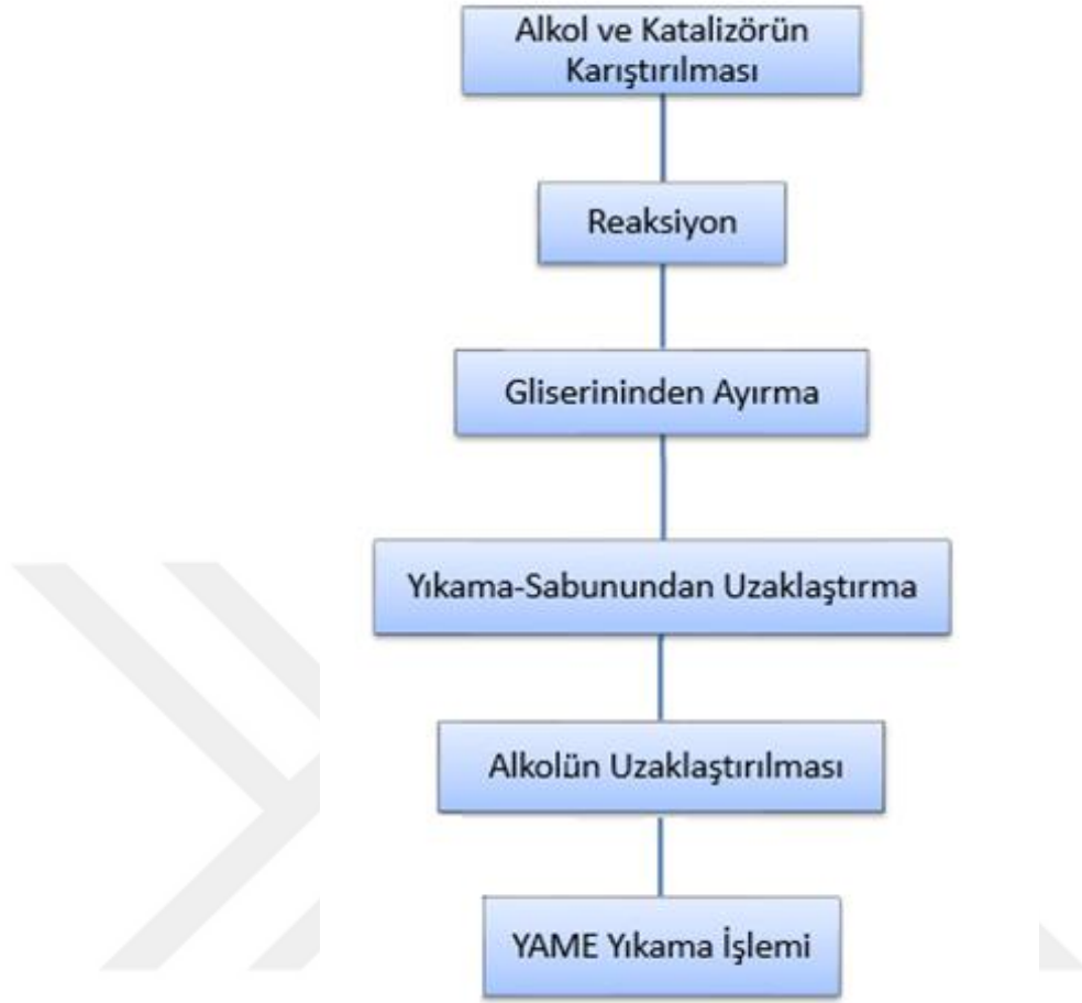
Şekil 2.8. Transesterifikasyon yöntemi işlem basamakları
