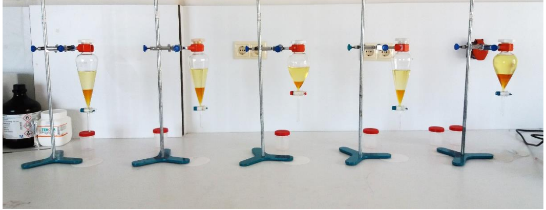
Şekil 3.8. Biyodizel ve gliserinin birbirinden ayrılması işlemi
