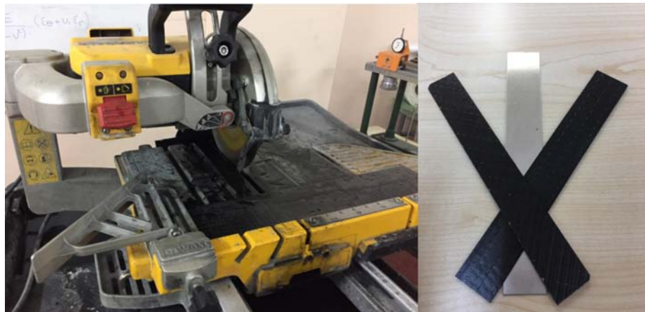
Şekil 2.5. Kompozit plakaların numune boyutlarına getirilmesi ve çalışmada kullanılan yüzey malzemeleri
