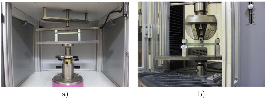
Şekil 2.8. (a) Numunelerin düşük hızlı darbe test cihazı ve (b) çekme-basma test cihazına bağlanması
