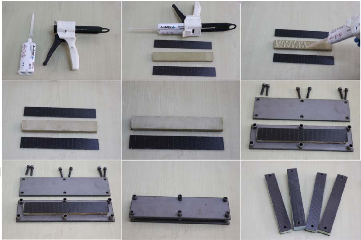
Şekil 2.7. Deney numunesi üretim aşamaları
