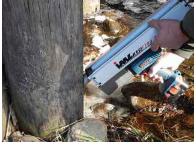
Şekil 2.17. Delme yöntemi ile tel direk muayenesi (Brashaw, 2015).
