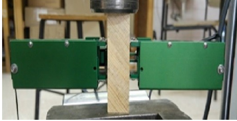
Şekil 3.5. Gökmar örneklerinde basma testleri.
