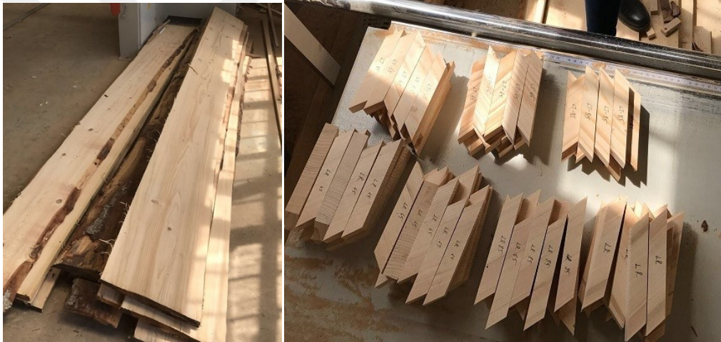
Şekil 3.3. Gök nar tomruklarından elde edilen keresteler ve test örnekleri.
