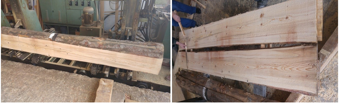
Şekil 3.2. Çalışmada kullanılan tomrukların biçilmesi.
