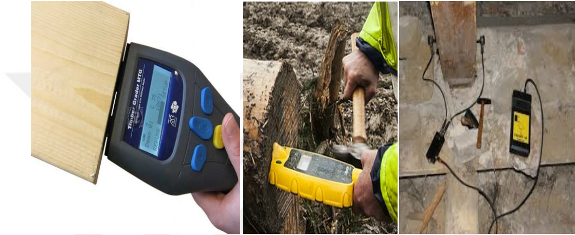
Şekil 2.16. Stres dalga prensibi ile çalışan cihazlara örnekler (broukhuis.com, fakopp.com)
