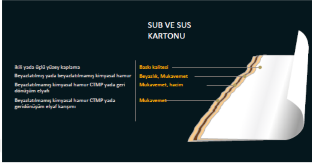
Şekil 5. 2 Sub ve sus kartonu katmanları [stora enso]
