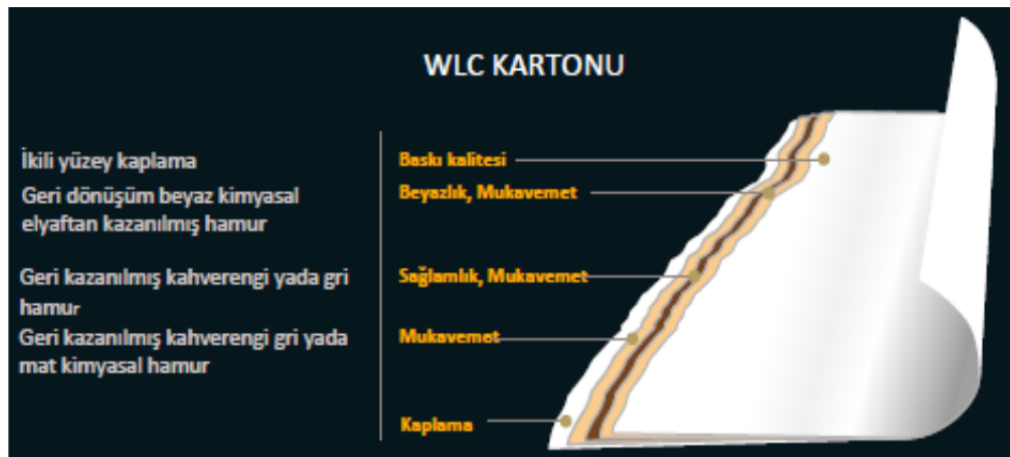
Şekil 5. 3 WLC kartonu katmanları [stora enso]
