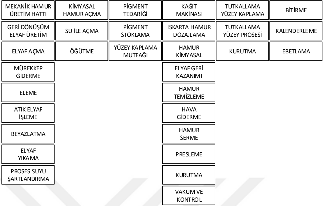
Şekil 5. 11 Kağıt üretim tesisi genel şeması [2]
