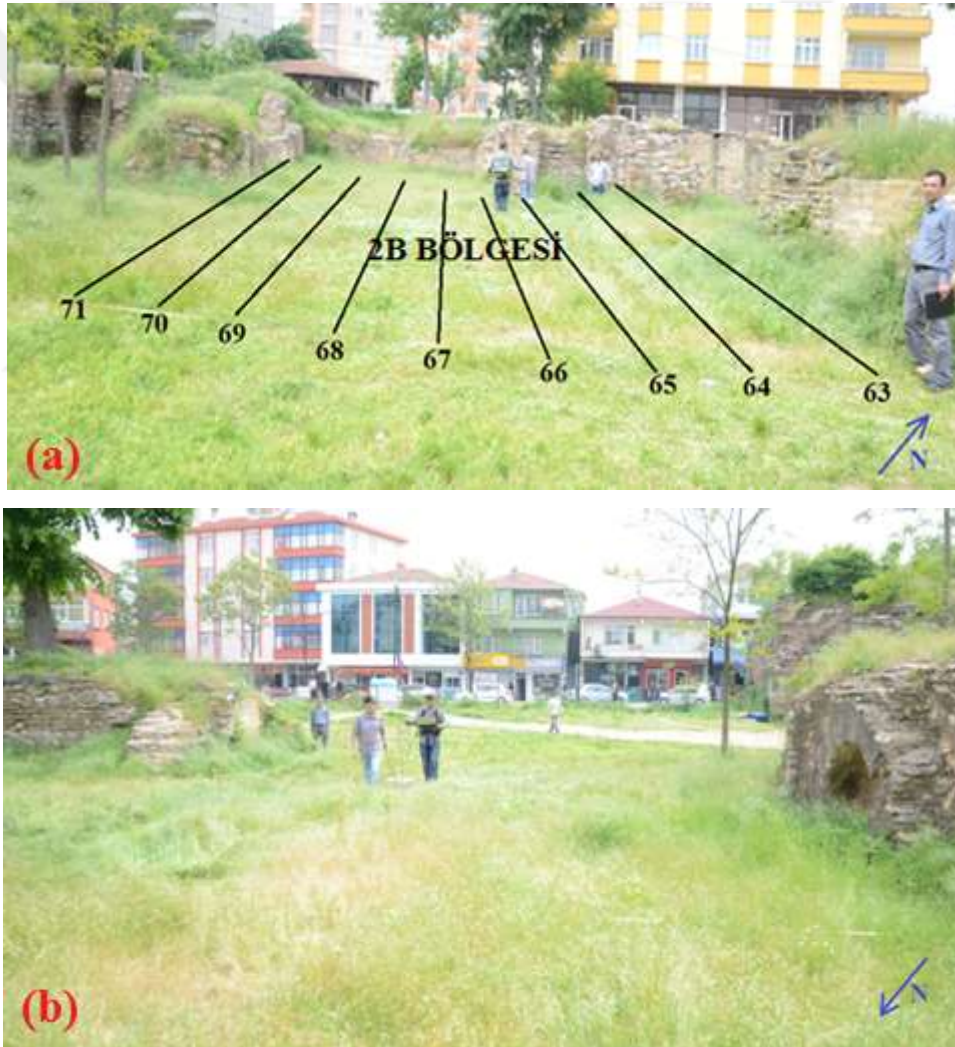
Şekil 4.27: a) Çalışma sahası 2B bölge GPR profil dizilimi b) GPR çalışmalarına ait genel görüntü.
