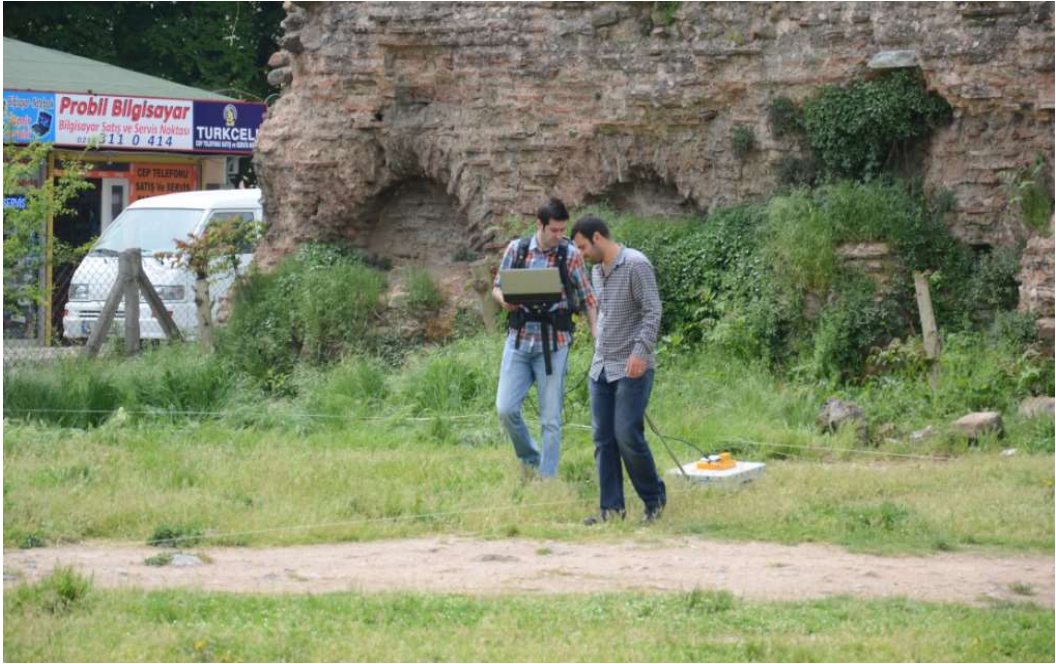
Şekil 3.9: Sahada gerçekleştirilen GPR çalışmasında ölçüm alınması ve kullanılan ekipman.
