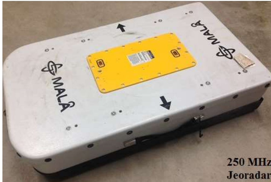
Şekil 3.7: Damatrys Sarayı veri toplama işlemine ait görüntüler 250 MHz Antenli Mala marka GPR Cihazı fotoğrafı (uwyo.edu /University of Wyoming sitesinden alınmıştır).
