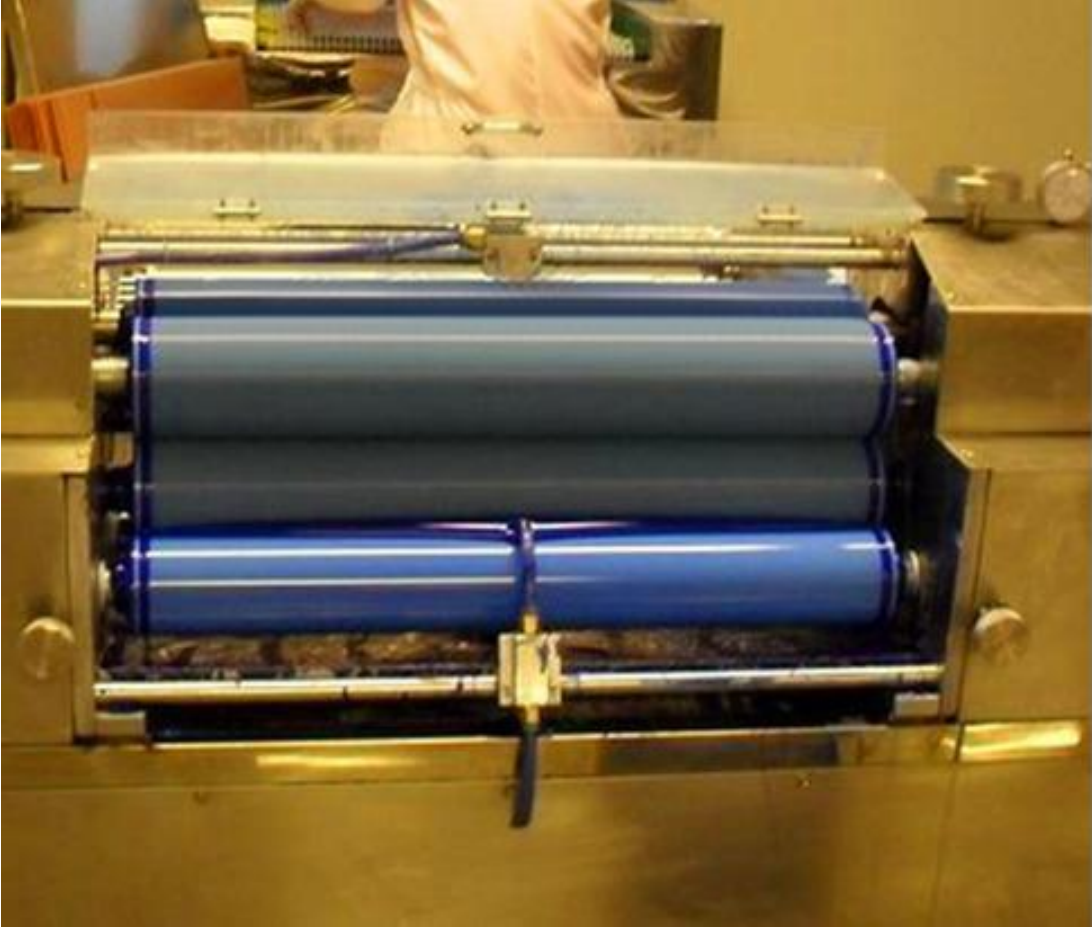
Şekil 4.12. Kart kaplamada kullanılan kuru film
