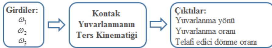
Şekil 4.3. Kontak yuvarlanmanın ters kinematiğinin girdileri ve çıktıları
