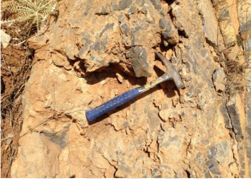
Şekil 4.19. H2 ölçülü kesitinde breşli seviye.
