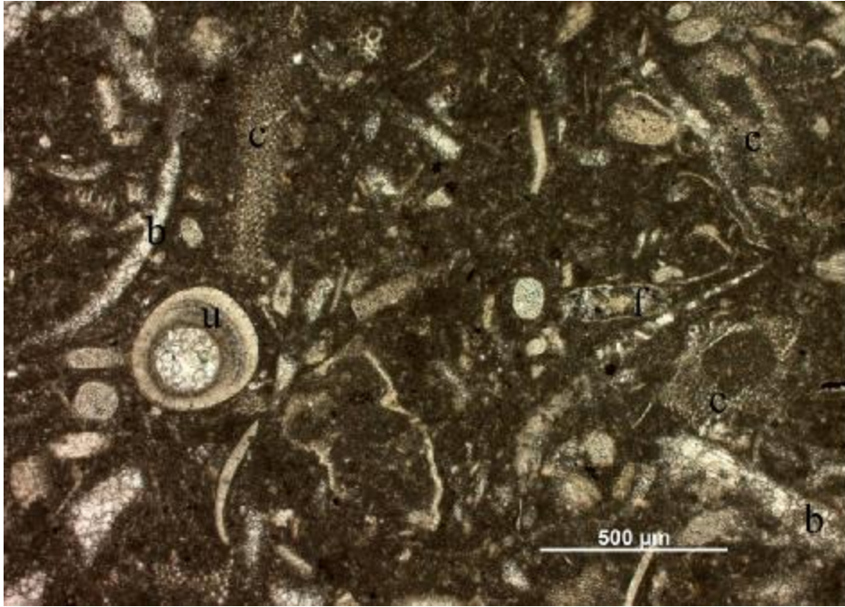
Şekil 4.87. Umbellinidli istifası fasiyesinin ince kesit görüntüsü (K2 Kesiti, K1-37), (u: umbellina, f: foraminifer, c: krinoid, b: bivalv).
