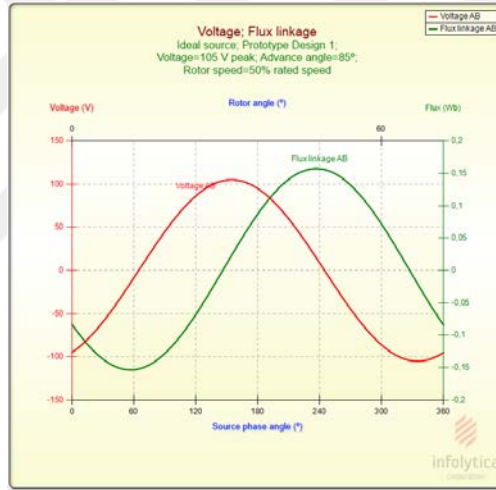
Şekil 4.6 Başlangıç açısı ayarlandığında akı-gerilim arasındaki 90°'lik faz farkı oluşumu.
