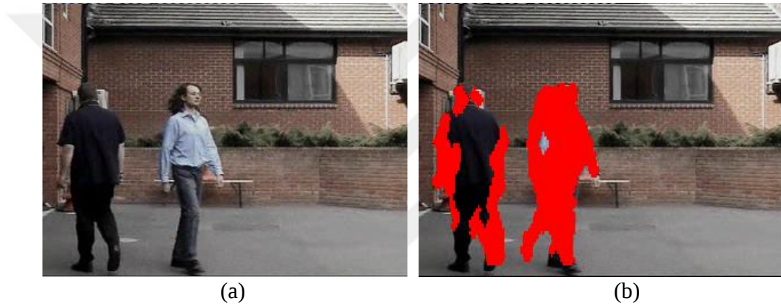
Şekil 2.2. Zamansal Farklılaşma Örneği. (a) İki hareketli nesneyle basit bir ekran görüntüsü. (b) Zamansal Farklılaşma aynı renkteki sol taraftaki nesnenin tüm hareket piksellerinin algılamada başarısız olduğu görüntü
