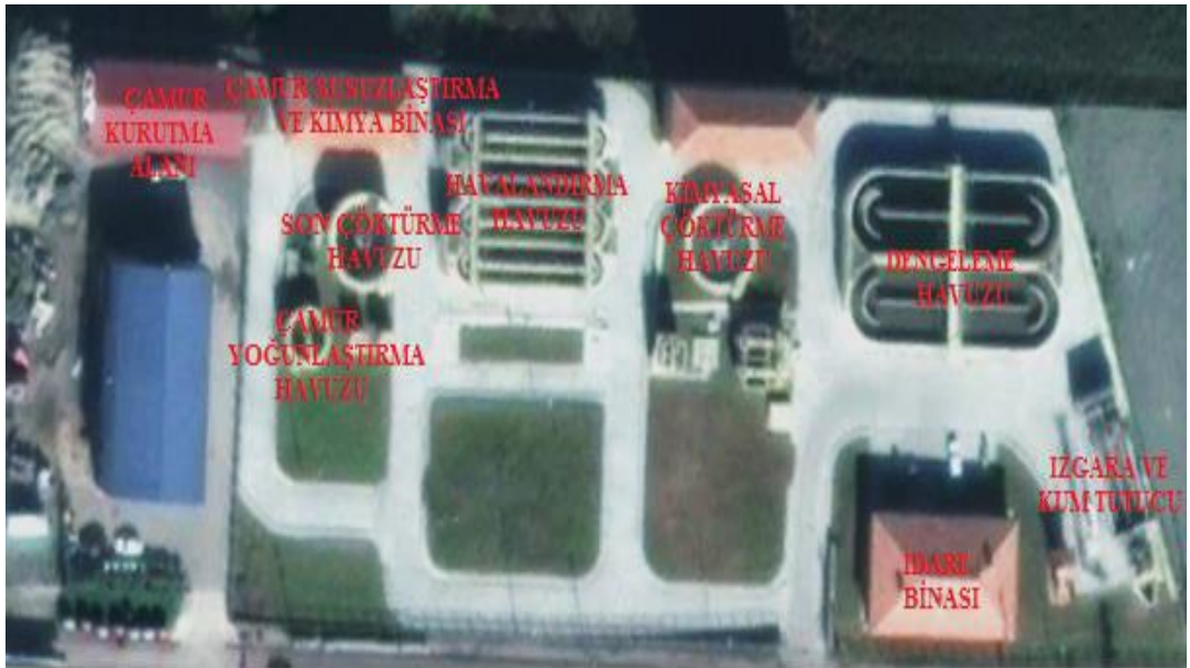
Şekil 3.2. Atıksu arıtma tesisi vaziyet planı
