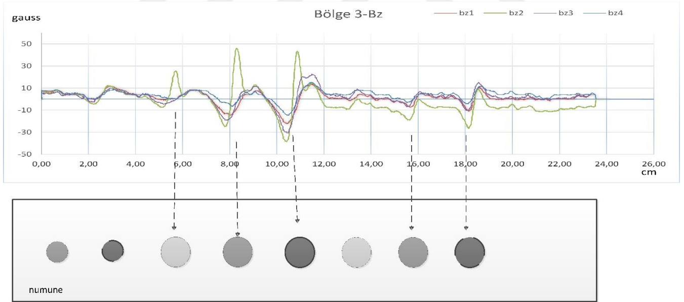
Şekil 3.43 Numune 3. Bölgesi için gerçekleştirilen deney sonucu Bz bileşeni
