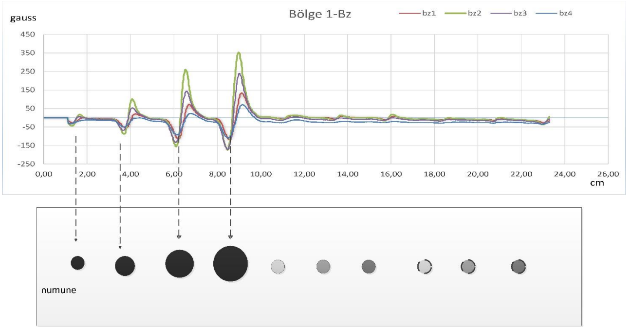
Şekil 3.25 Numune 1. Bölgesi için gerçekleştirilen deney sonucu Bz bileşeni
