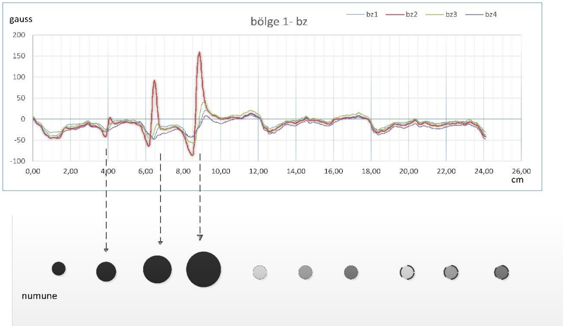
Şekil 3.33 Numune 1. Bölgesi için gerçekleştirilen deney sonucu Bz bileşeni
