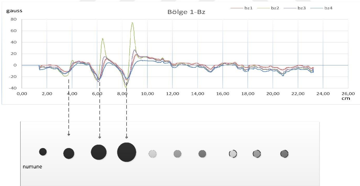
Şekil 3.39 Numune 1. Bölgesi için gerçekleştirilen deney sonucu Bz bileşeni
