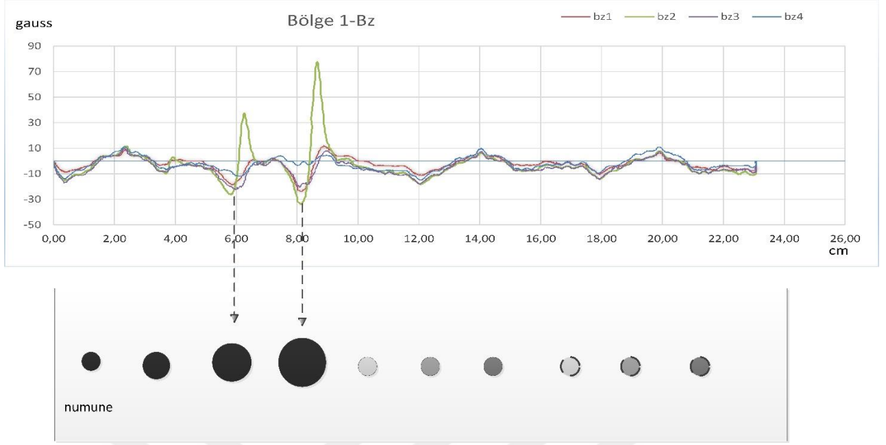
Şekil 3.53 Numune 1. Bölgesi için gerçekleştirilen deney sonucu Bz bileşeni
