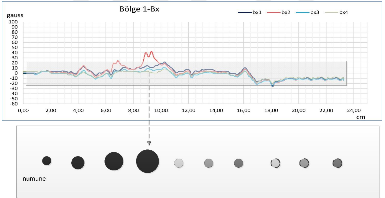
Şekil 3.46 Numune 1. Bölgesi için gerçekleştirilen deney sonucu Bx bileşeni
