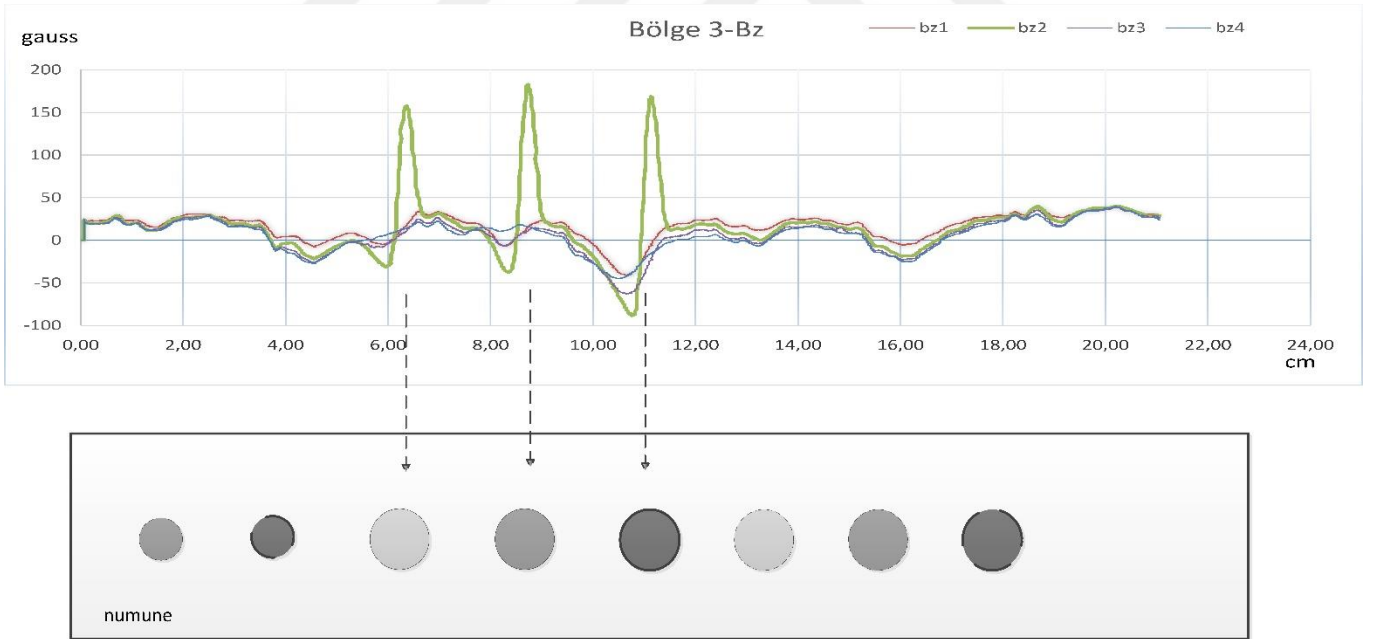
Şekil 3.51 Numune 3. Bölgesi için gerçekleştirilen deney sonucu Bz bileşeni
