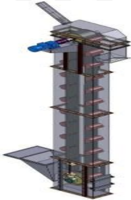
Şekil 1.3. Lastik bantlı elevatörün genel görünüşü [11].
