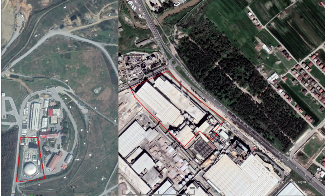
Şekil 5.10 : Biyokütle santrallerinin arazi kullanımının poligonlar ile belirlenmesi (Çöp gazı, orman yan ürünü- Google Earth ekran görüntüsü).
