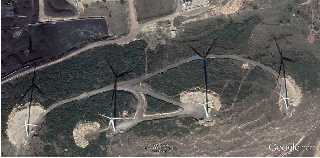
Şekil 4.7 : Aynı tepenin farklı yerlerinde, aynı tip RT'lerinin yerleştirilirken sebep olduğu arazi değişimi (Google Earth ekran görüntüsü).
