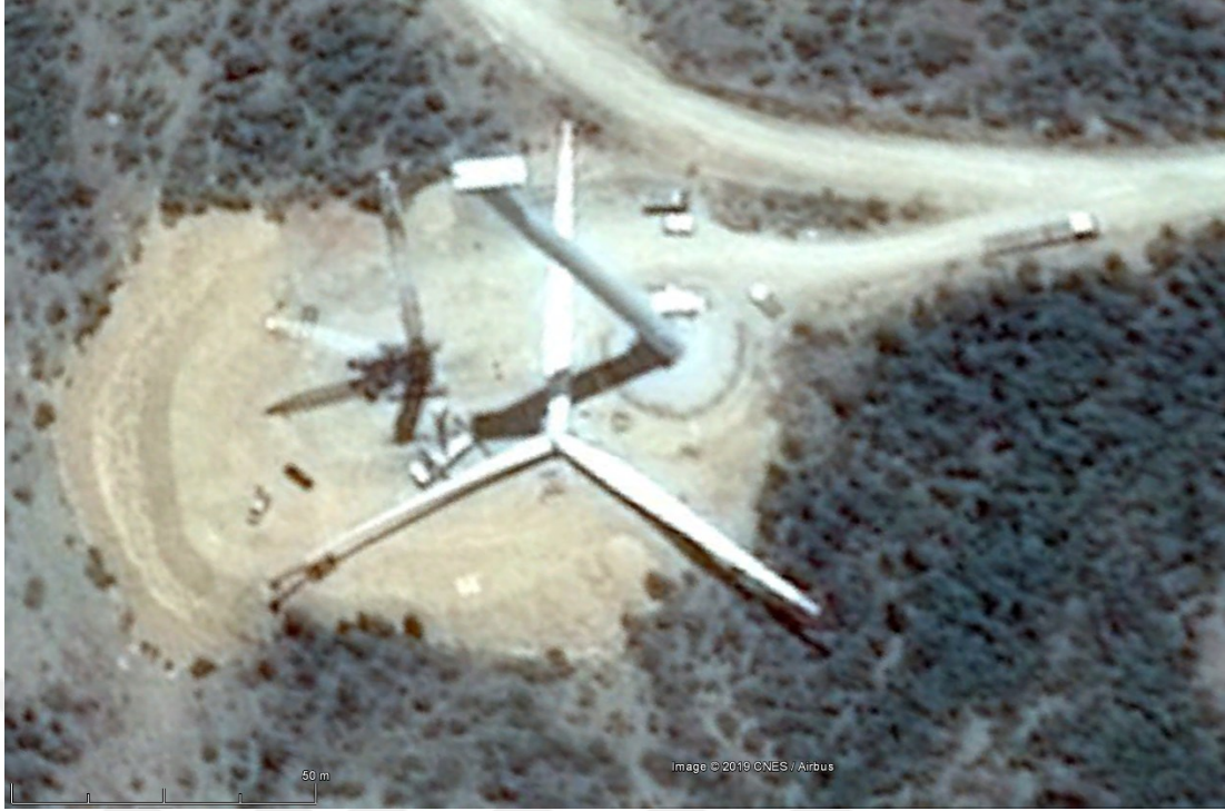
Şekil 4.9 : Rotor yerde birleştirilmiş ve kaldırılmayı bekliyor. (Google Earth Ekran görüntüsü).
