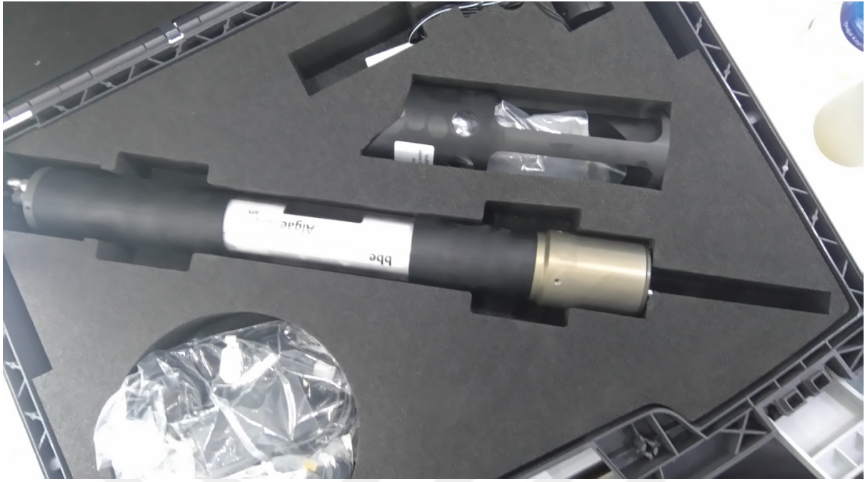
Şekil 3.2.2. BBE MoldaenkeAlgae Torch100 Cihazı
