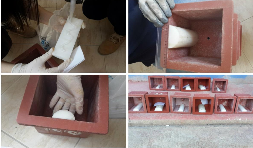
Şekil 3.2. Teflon malzemenin yapıştırılması
