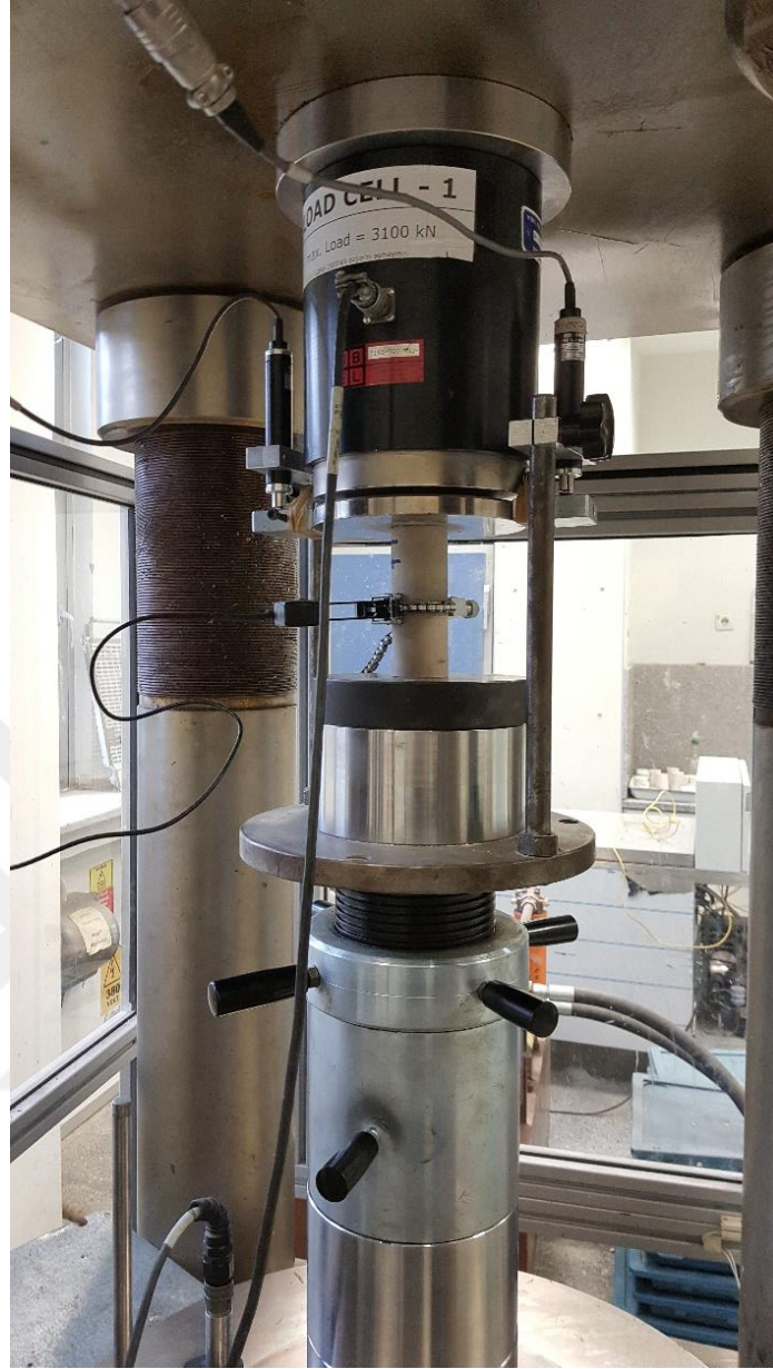
Şekil 4.10 : Tek eksenli basınç dayanım deneyi.
