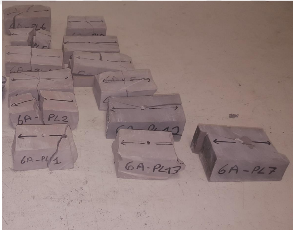
Şekil 4.5 : AT-6 kodlu nokta yük numuneleri deney sonrası.
