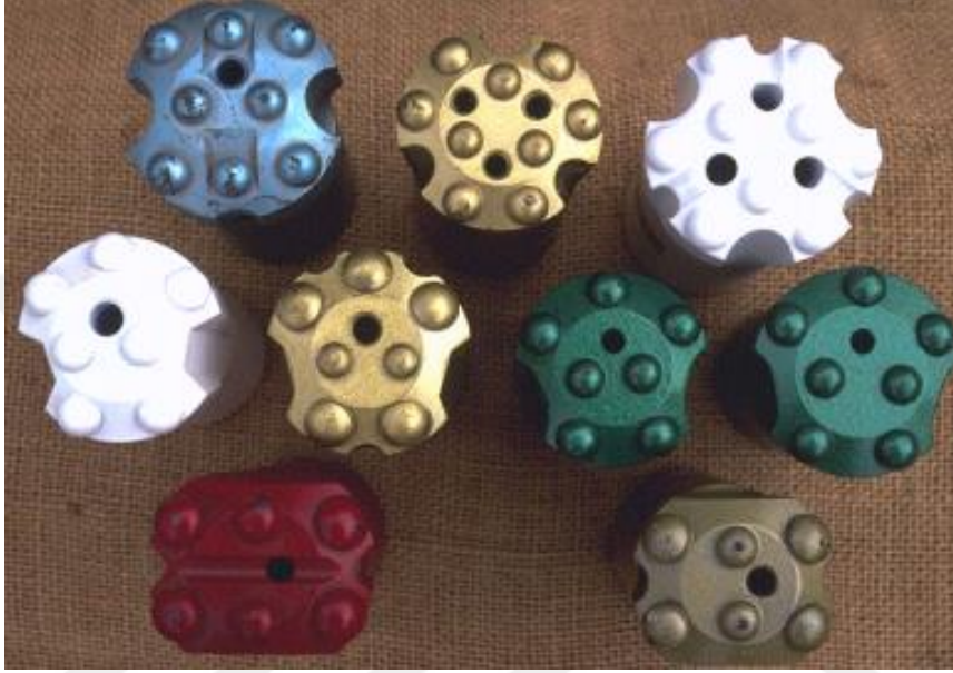
Şekil 2.15 : Döner darbeleri delmede kullanılan matkaplar.
