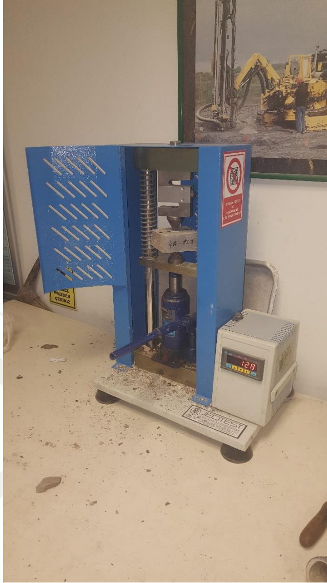
Şekil 4.6 : Nokta yük deneyi.
