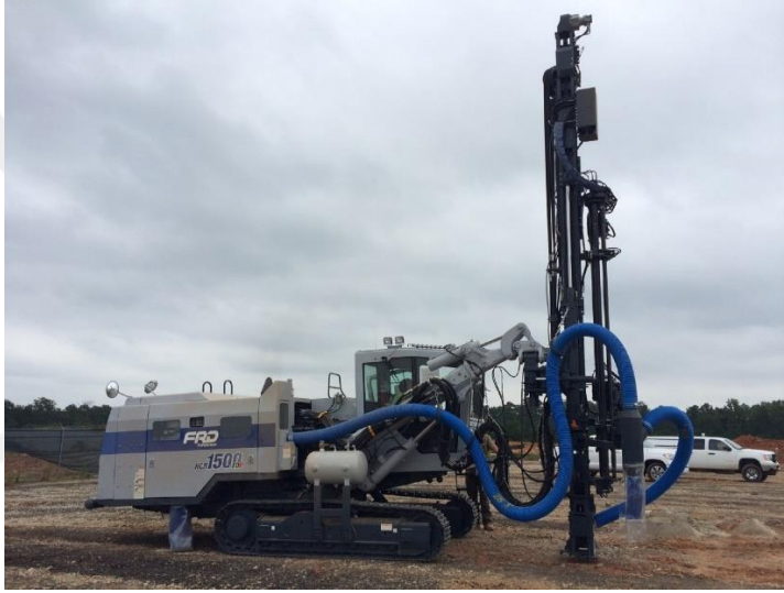
Şekil 2.3 : Hidrolik darbeli delici makine.
