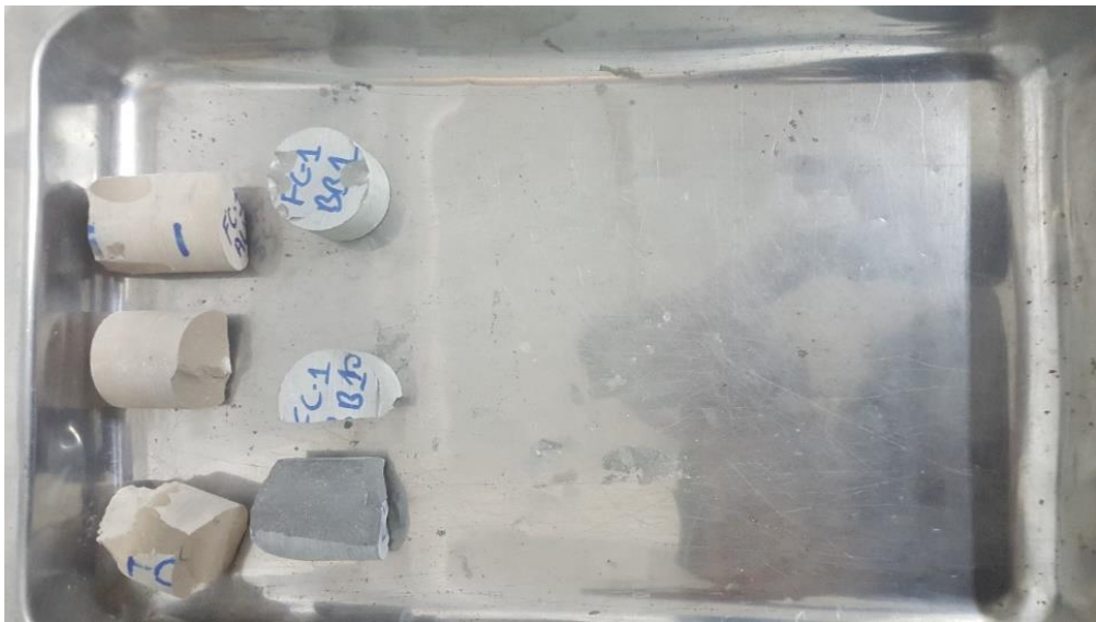
Şekil 4.16 : Nem içeriđi deneyinde kullanılan numuneler.
