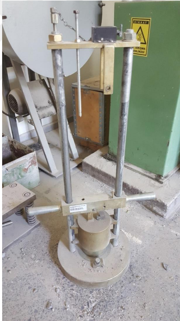
Şekil 4.14 : Darbe dayanımı deneyi.
