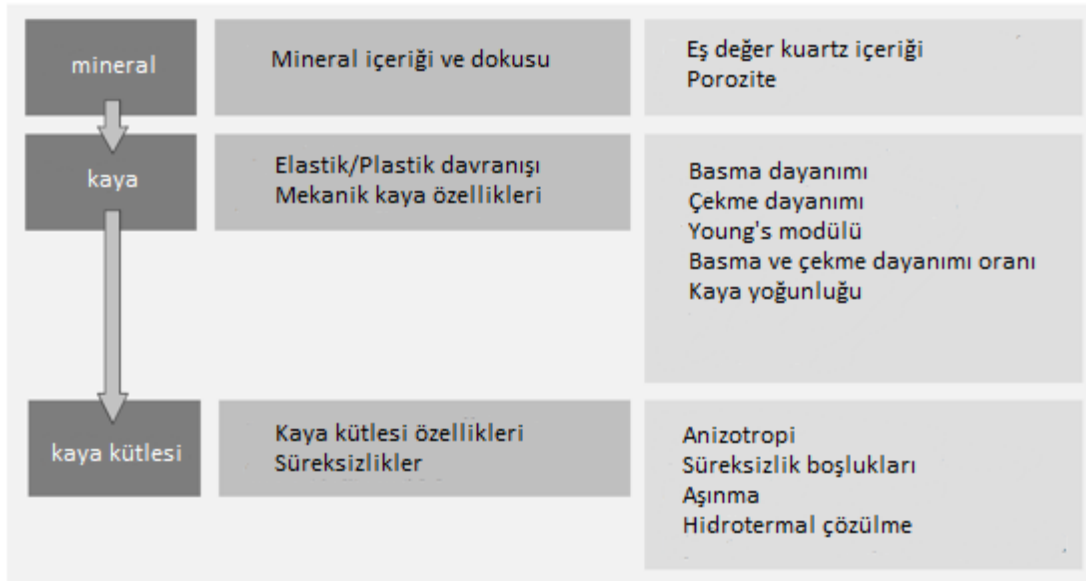
Şekil 2.19 : Jeolojik Parametreler: Mineral, kaya ve kaya kütlelerinin karakteristiklerine genel bakış [5].
