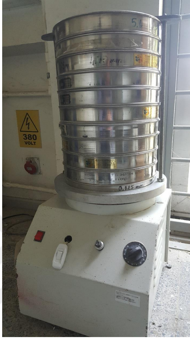
Şekil 4.7 : Elek analizi deneyinde kullanılan titreşimli eleme makinesi.
