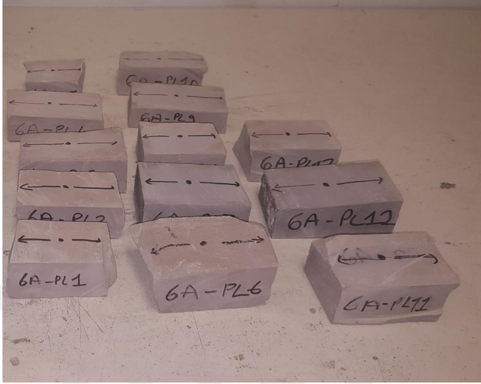
Şekil 4.4 : AT-6 kodlu nokta yük numuneleri deney öncesi.
