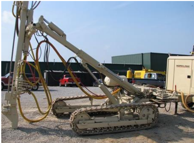
Şekil 2.4 : Pnömatik darbeli delici makine.
