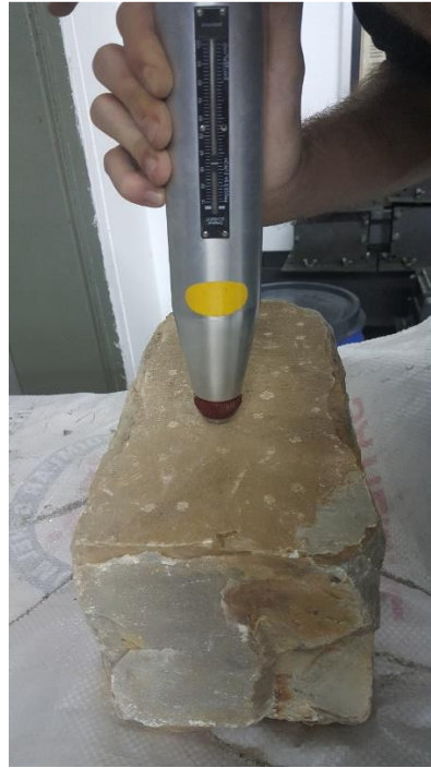
Şekil 4.3 : Schmidt çekici deneyi.
