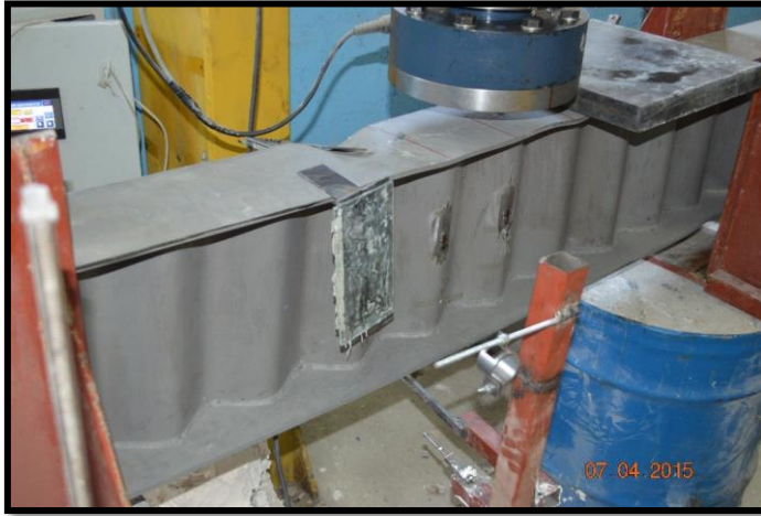
Şekil 4.7. OGK_330_Test_1 göçme durumu
