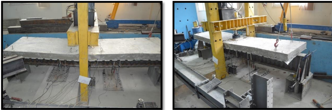
Şekil 4.60. OGKK_500 döşeme kirişleri İki noktadan yükleme göçme durumları
