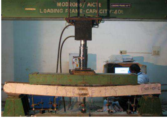
Şekil 2.17. Abraham (2013) beton dolgulu kiriş testi
