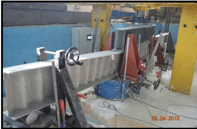
Şekil 4.17. OGK_330_Test_5 yanıl burkulma durumu
