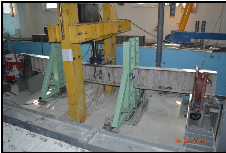
Şekil 4.39. OGK_415_Test_13 tekil yükleme durumu
