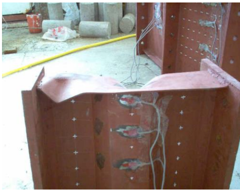
Şekil 2.9. Dabon ve Elamary (2006) TGK göçme durumu
