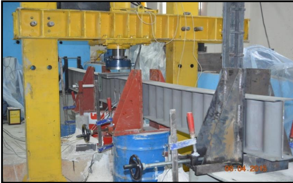
Şekil 3.12. Ondülin gövdelerin kiriş test tekil yükleme durumu
