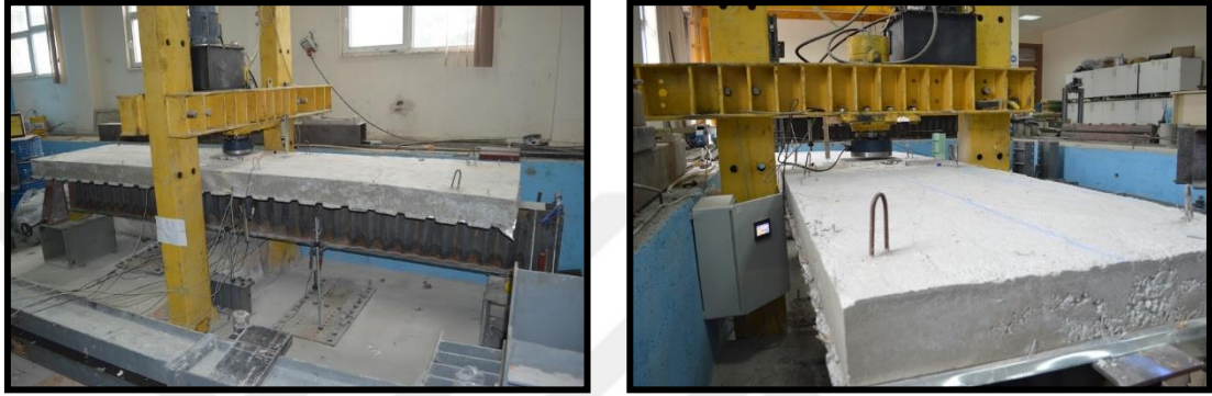
Şekil 3.25. OGK_500 döşeme kirişleri üzerinde tekil yükleme durumu
