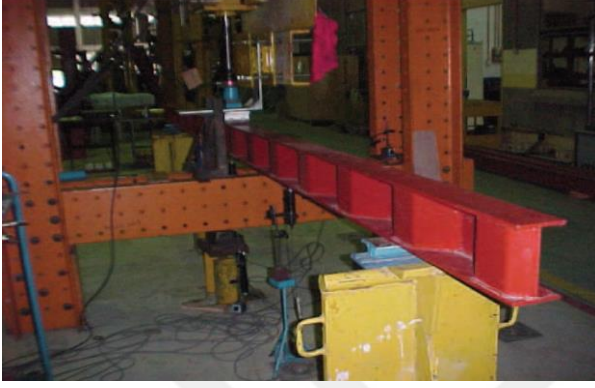
Şekil 2.13. Denan, Saad ve Osman (2009) majör ekseninde elastik eğilme testi
