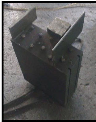
Şekil 3.8. Gövdenin ondülin forma getirilmesi için hazırlanan kalıp
