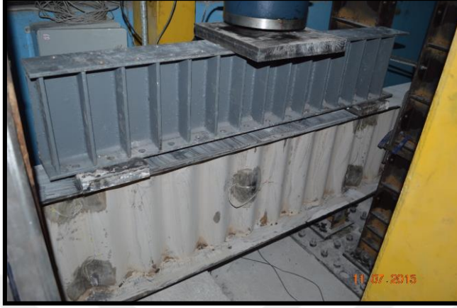
Şekil 4.30. OGK_500_Test_10 iki noktadan yükleme durumu
