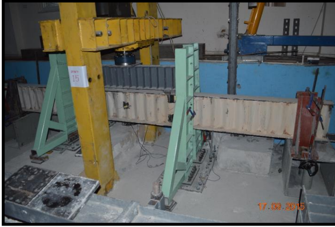
Şekil 4.45. Ondülin gövdelerin kiriş test iki noktadan yükleme durumu
