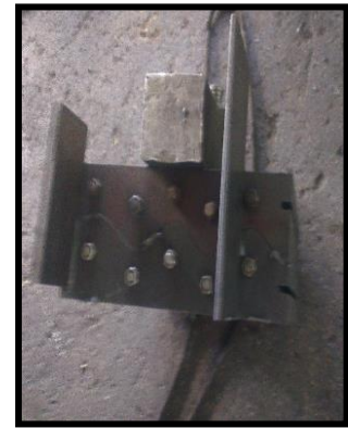
Şekil 3.8. Gövdenin ondülin forma getirilmesi için hazırlanan kalıp
