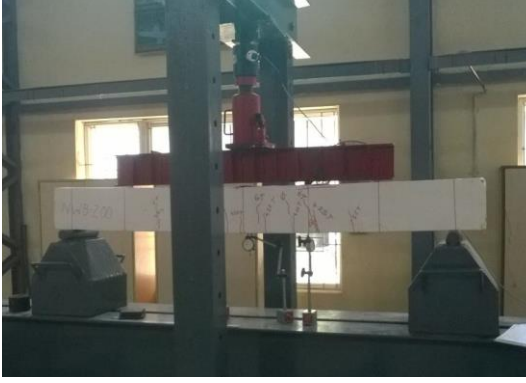
Şekil 2.43. Mathe ve Parthasarathi (2015) beton dolgulu ZGK eğilme testi
