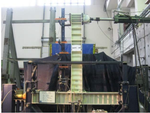
Şekil 2.36. Aydın vd. (2016) SGK göçme durumu
