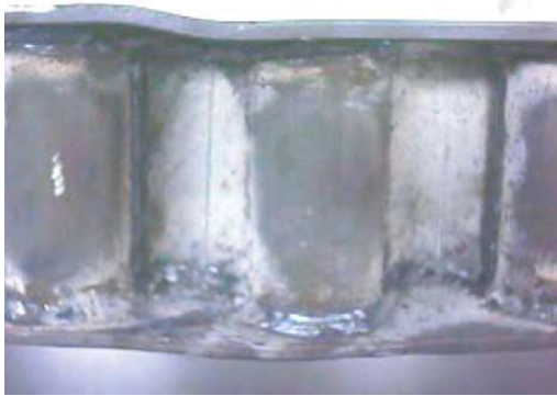
Şekil 2.27. Khalid vd. (2004) dikey SGK göçme sonrası görünüm
