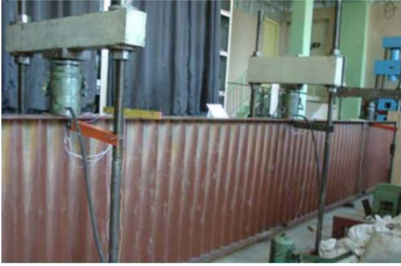
Şekil 2.39. Zubkov vd. (2018) iki noktadan yükleme deney düzeni
