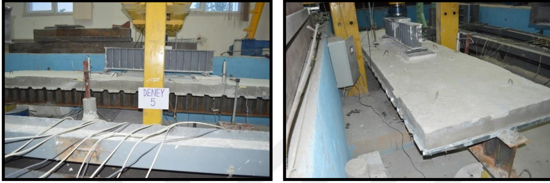
Şekil 3.23. OGK_330 döşeme kirişleri üzerinde iki noktasal yükleme durumu
