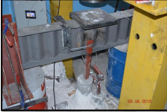
Şekil 4.8. OGK_330_Test_2 göçme durumu
