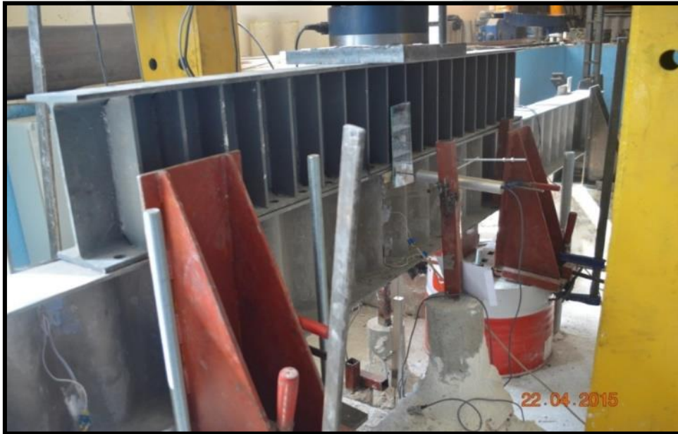
Şekil 3.17. Ondülin gövdelerin kiriş düzgün yayılı yükleme durumu
