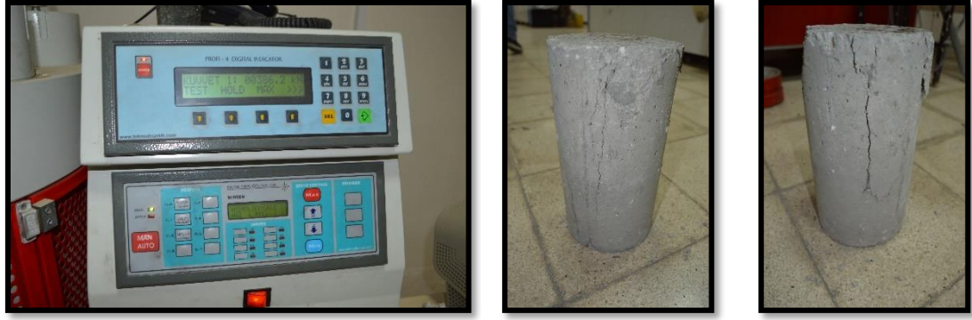
Şekil 4.65. Ondülin gövdeli kompozit döşeme kirişinin beton basınç deneyi
