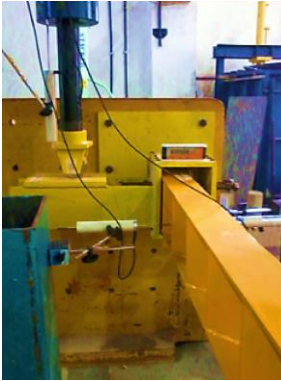
Şekil 2.44. Denan vd. (2016) ZGK burulma testi
