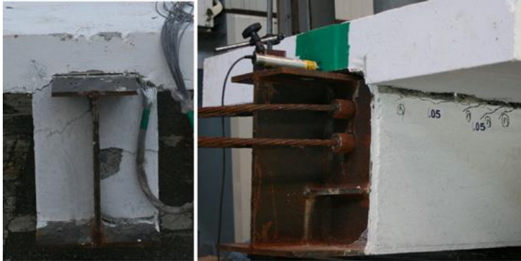
Şekil 2.15. Kim ve Lee (2011) yatay kesme göçmesi durumu
