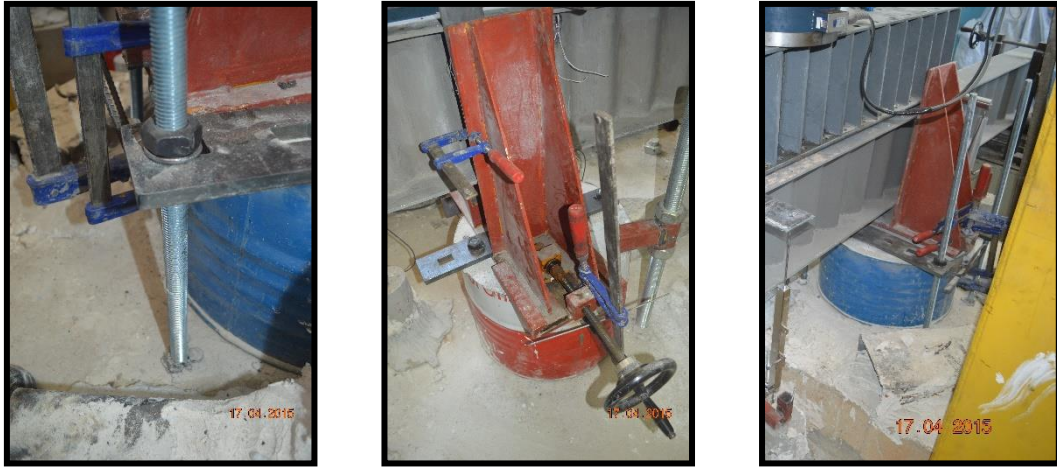
Şekil 3.16. OGK_330_Test_3 sonrası bayrak levhalarının sabitlenmesi
