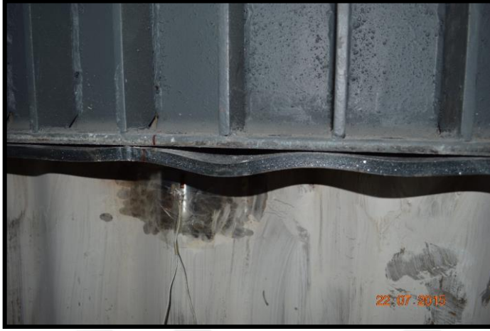
Şekil 4.36. OGK_500_Test_12 göçme durumu
