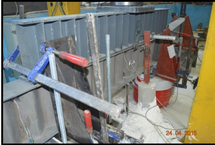
Şekil 4.19. OGK_330_Test_6 göçme durumu
