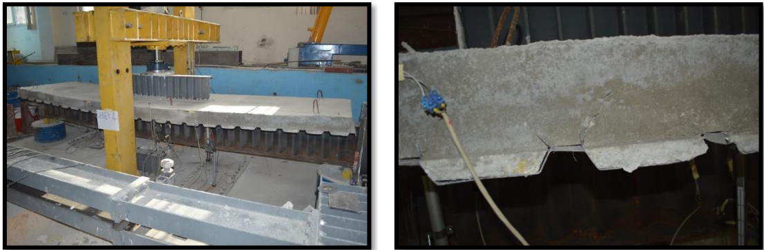
Şekil 4.58. OGKK_415 döşeme kirişleri düzgün yayılı yükleme göçme durumları
