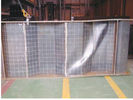
Şekil 2.8. Gil vd. (2005) kiriş numunesinin deformasyonu
