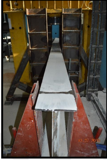
Şekil 4.34. OGK_500_Test_11 yanıl burkulma durumu
