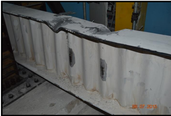
Şekil 4.23. OGK_500_Test_7 göçme durumu
