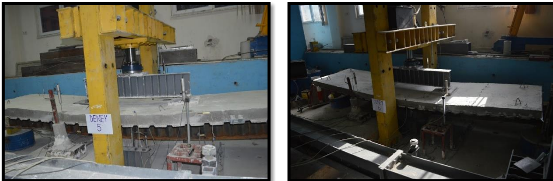
Şekil 4.56. OGKK_330 döşeme kirişleri iki noktadan yüklemeye göçme durumları
