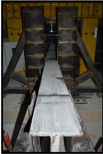
Şekil 4.31. OGK_500_Test_10 göçme durumu
