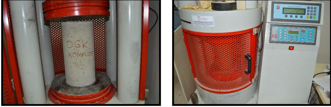
Şekil 3.28. OGKK beton basınç deney düzeneği
