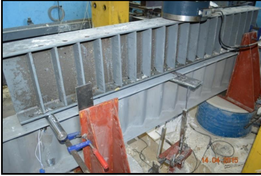
Şekil 3.15. OGK testi iki noktadan yükleme durumu
