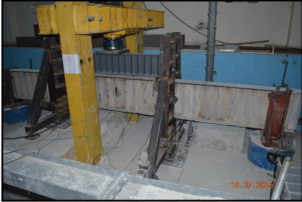
Şekil 3.20. Ondülin gövdelerin kiriş test tekil yükleme durumu
