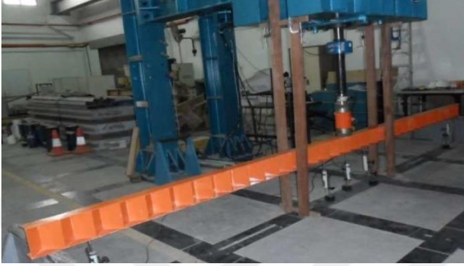
Şekil 2.42. Denan ve Hashim (2013) eğilmeye maruz kalan ZGK
