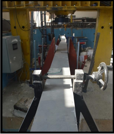
Şekil 4.12. OGK_330_Test_3 yanal burkulma durumu
