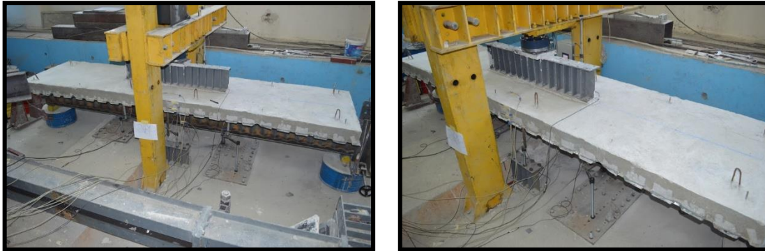
Şekil 3.24. OGKK_415 üzerinde düzgün yayılı yükleme durumu
