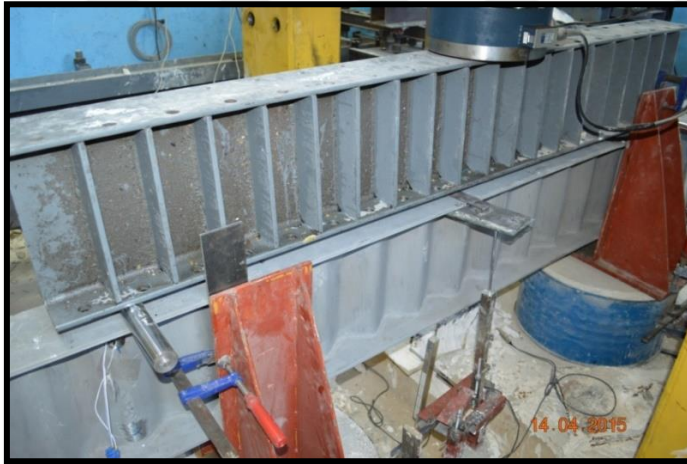
Şekil 4.11. OGK_330 iki noktadan yükleme durumu
