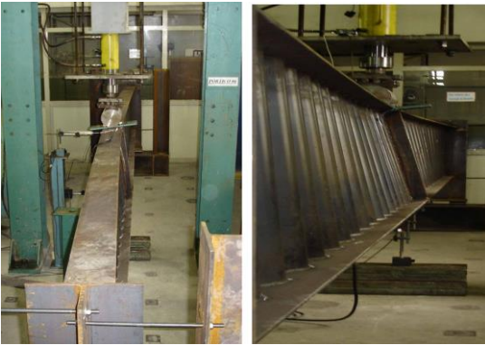
Şekil 2.35. Pimenta vd. (2015) SGK göçme durumu
