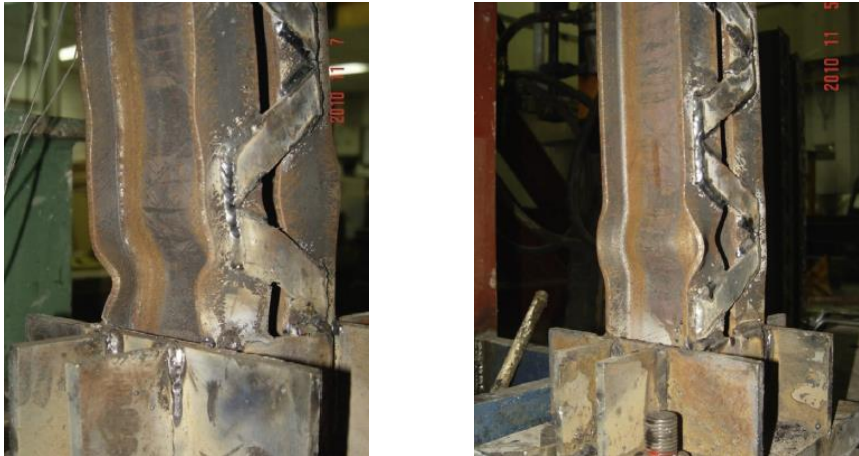
Şekil 4.13 : Elemanların deney sonucundaki göçme modları [19].
