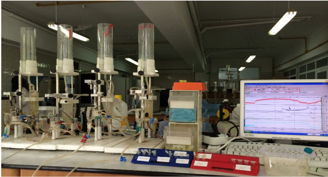
Şekil 2.2. İn vitro deneyler için kullanılan organ banyosu sistemi
