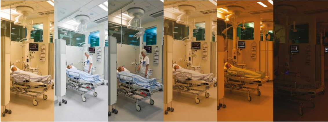
Şekil 4.14. Hastane odasında uygulanmış bir insan odaklı aydınlatma çalışmasının günün farklı saatlerindeki görünüşleri [52]
