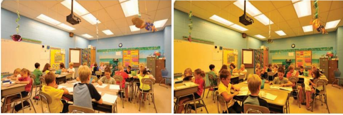
Şekil 4.13. Eğitim ortamında uygulanmış insan odaklı aydınlatma sisteminin farklı renk sıcaklıklarındaki görünüşleri [33]
