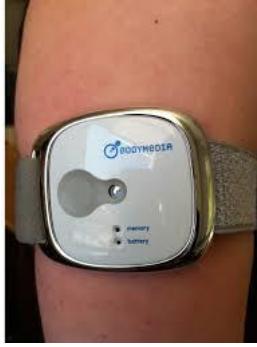
Şekil 3.4. Kola takılarak ölçüm yapan akselerometre.
