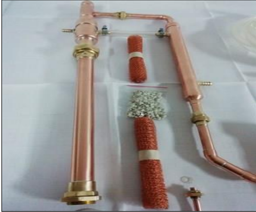
Şekil 3.7. Bakır damıtma kulesinin iç ve dış yapısı görünümü
