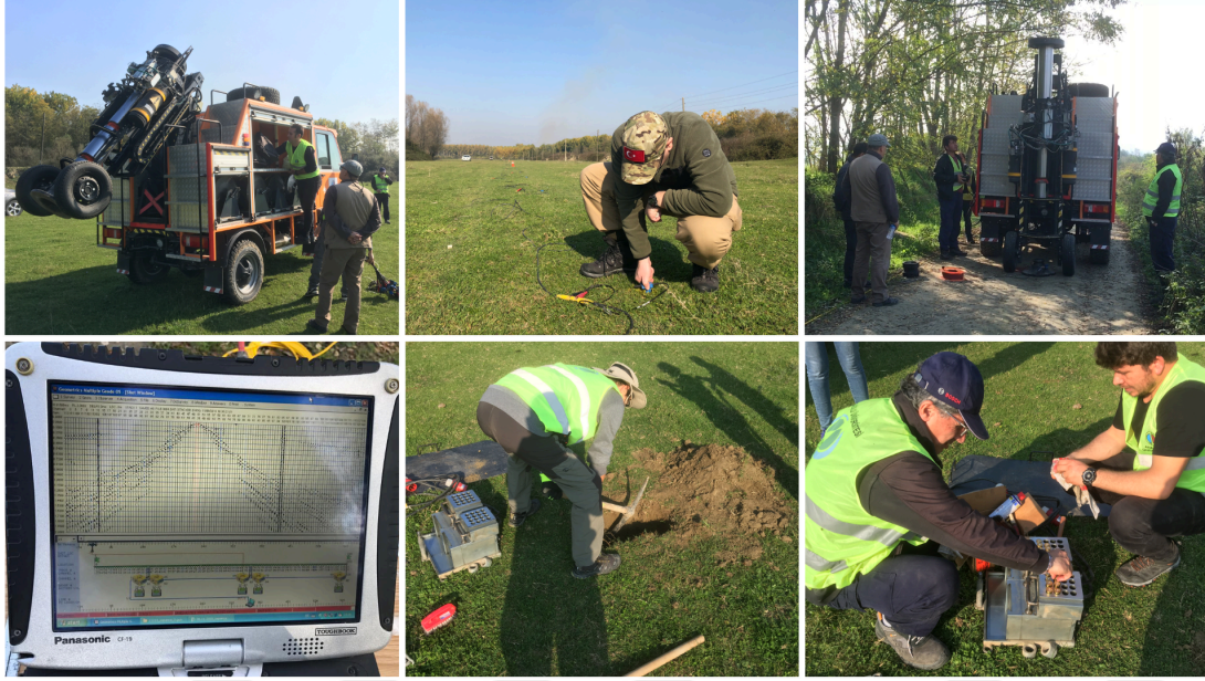
Şekil 4.1 : Sismik yansıma verilerinin toplanmasında kullanılan ekipmanlara ve arazideki veri toplama çalışmalarına ait görüntüler.
