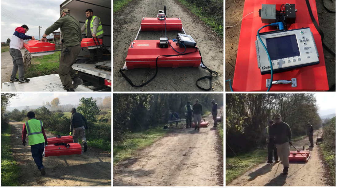
Şekil A.1 : Yer radarı verilerinin toplanmasında kullanılan ekipmanlara ve arazideki veri toplama çalışmalarına ait görüntüler.
