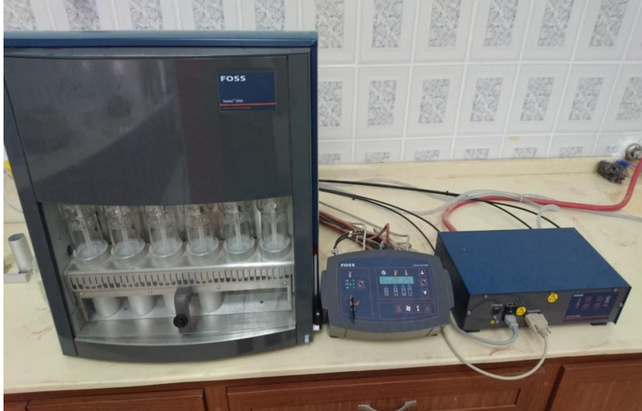
Şekil 3.20. FOSS Soxtec 2050 marka yağ ve gres tayin cihazı
