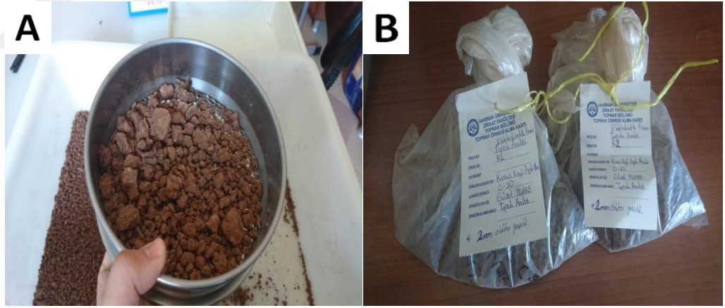
Şekil 3.4. Şekil-A ve Şekil-B’de 2mm’lik elekler ile elenip ve kurutulmuş toprak örnekleri
