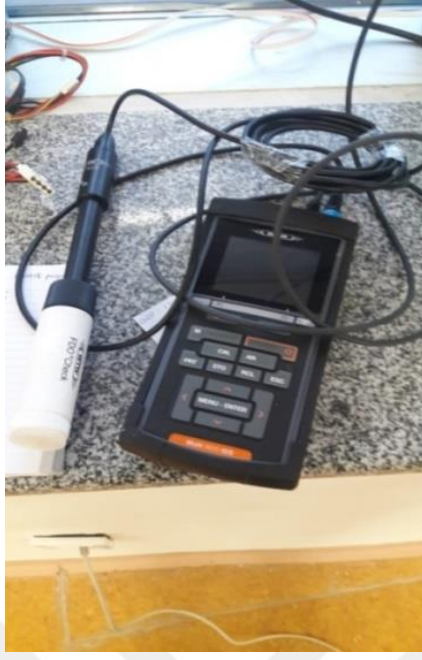
Şekil 3.19. WTW Multi 3620 IDS marka cihazın görünümü
