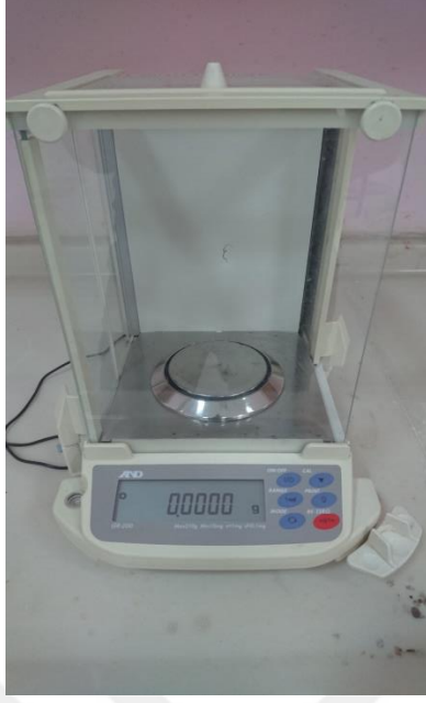
Şekil 3.7. Toprak tarımlarında kullanılan hassas terazi (AND GR-200)
