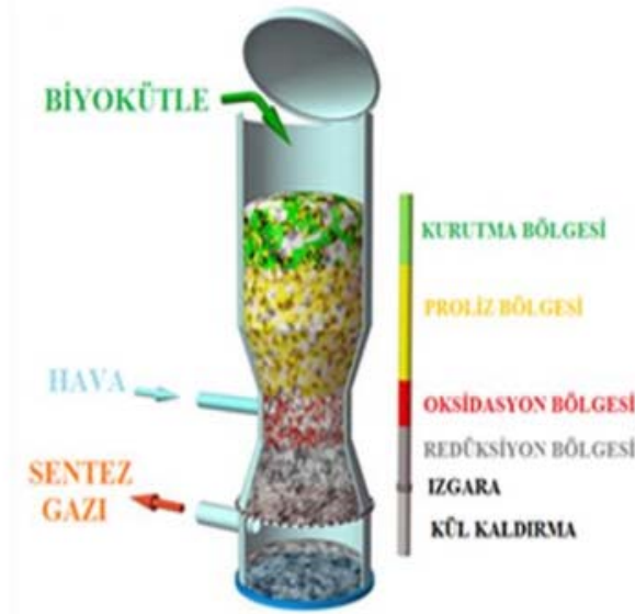
Şekil 3.3: Reaktör içerisindeki gazlaştırma aşamaları (Demirtaş & Danışmaz, 2016).
