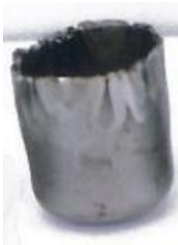
Şekil 2.17 : Derin çekme sonucu oluşan kırışma [22].
