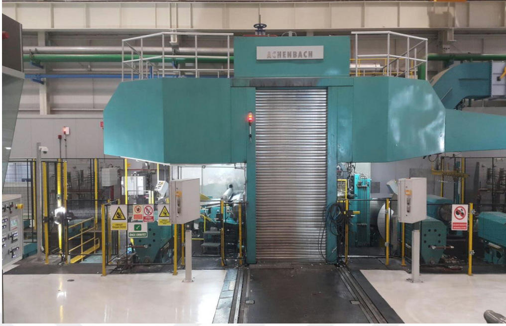
Şekil 4.3 : Achenbach Four-High-Mill folyo hadde makinası.
