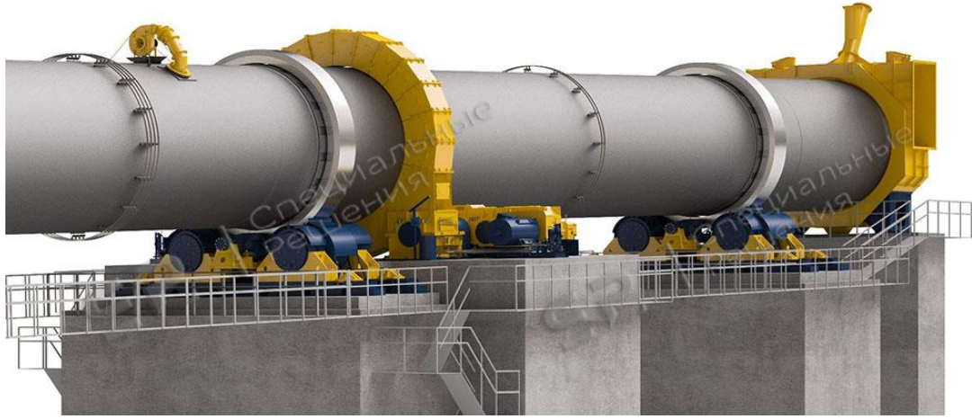
Şekil 2.6 : Alümina üretiminde kullanılan döner fırın [8].
