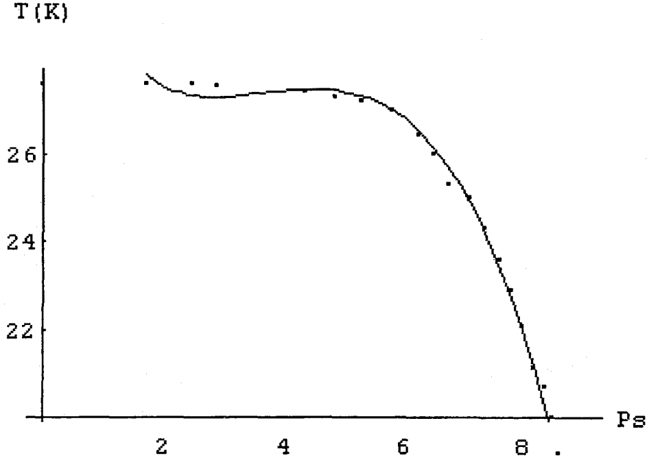
Şekil.3.10. Polarizasyonun sıcaklıkla değişim grafiği. Burada noktalar triglycine selenate kristali için deneysel verileri gösterir. Eğri ise uydurma ile bulunan denklem (3.32)'yi temsil eder.
