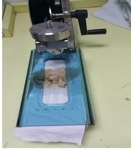
Şekil 3.7. Sürtünme haslığı test cihazı
