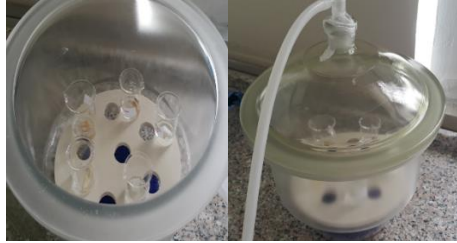
Şekil 3.6. Vakumlu desikatörde vakumlama işlemi
