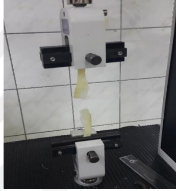
Şekil 4.26. Çeneler arasında test sonrası kopmuş pamuk kompozit yapı
