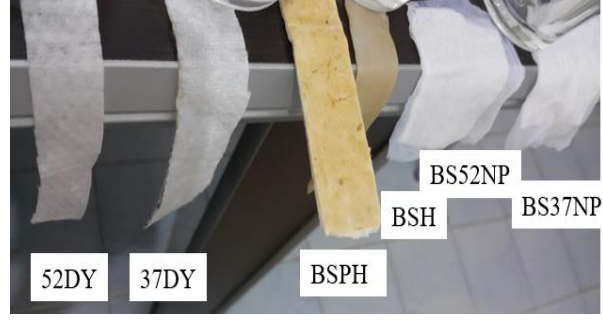
Şekil 4.29. BS, BS kompozit yapılar ve dokusuz yüzeylerin eğilme davranışı
