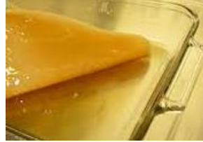
Şekil 2.10. Statik kültür yöntemi ile üretilmiş BS yapı (Zeng, 2014)
