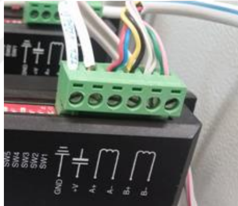
Şekil 3.4. Sekiz kablolu step motorun sürücüye bağlantısı.
