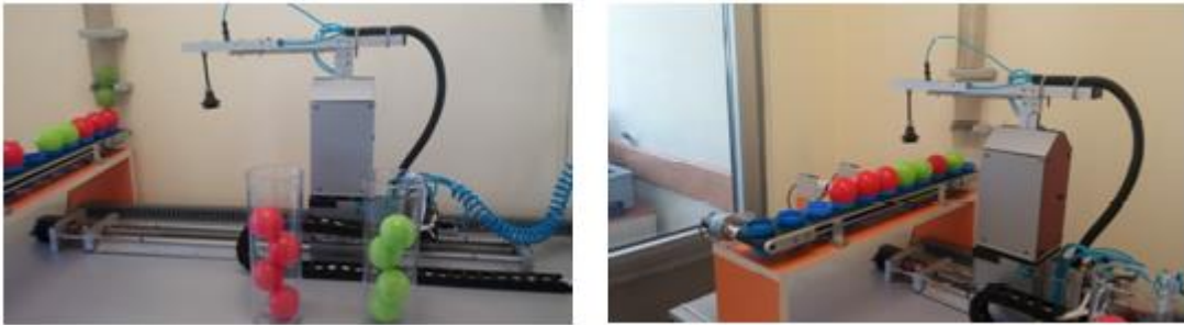
Şekil 4.10. Robot kol bekleme pozisyonu ve vidalı milin kırmızı topa gitmesi.
