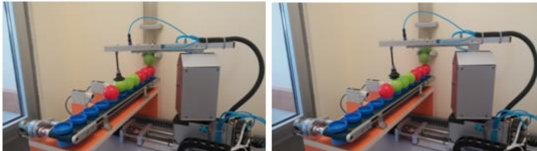
Şekil 4.15. Kolun yeşil topa dönmesi ve kolun aşağı inmesi ve vakum işlemi.
