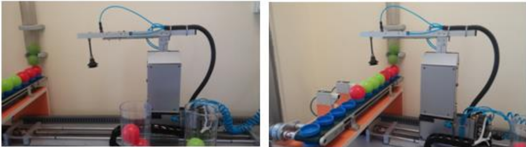
Şekil 4.14. Robot kolun bekleme pozisyonu ve tablanın yeşil topa gitmesi.
