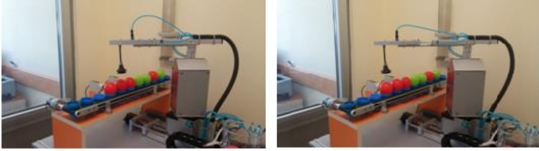
Şekil 4.11. Kol step motorunun dönmesi ve robot kolun ileri yönde uzaması.
