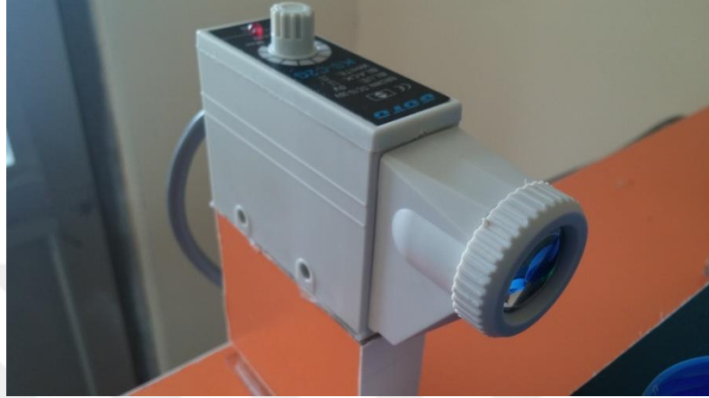
Şekil 3.8. Robot kolda kullanılan renk sensörü.
