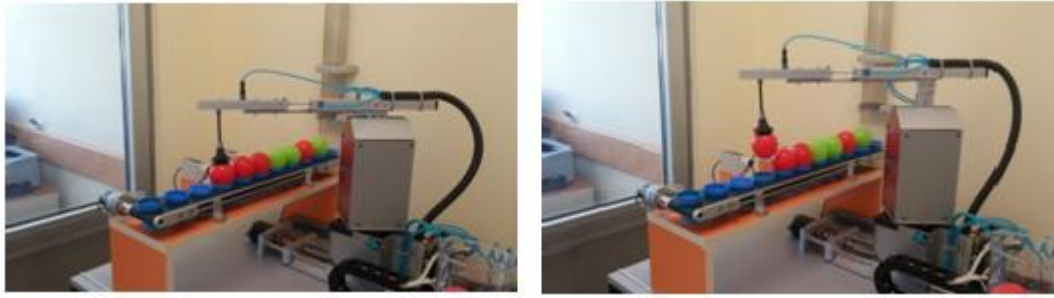
Şekil 4.12. Robot kolun aşağı inmesi ve vakum işlemi ile kolun yukarı kalması.
