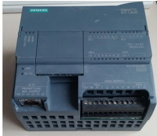
Şekil 3.1. S7 1200 PLC cihazı ve birimleri.
