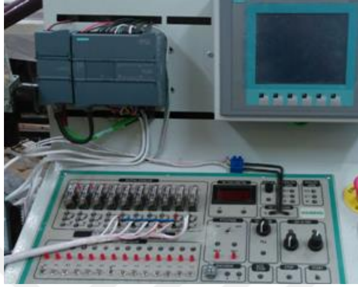
Şekil 4.9. Robot Kol uçlarının PLC cihazına bağlantısı.
