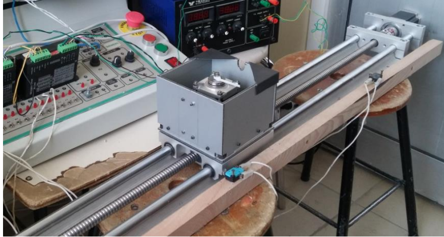
Şekil 3.10. Çalışmada kullanılan vidalı mil ve tablası.
