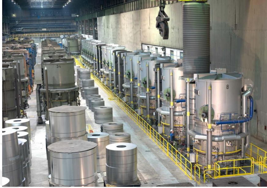
Şekil 4.4: Çan tipi tavlama fırın örneği (Url-4).
