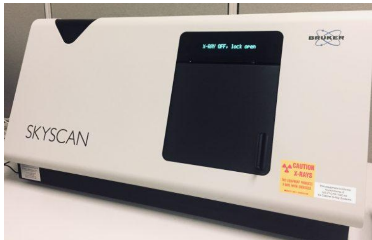
Şekil 3.16: Radyolojik inceleme iin kullanılan mikro bilgisayarlı tomografi cihazı
