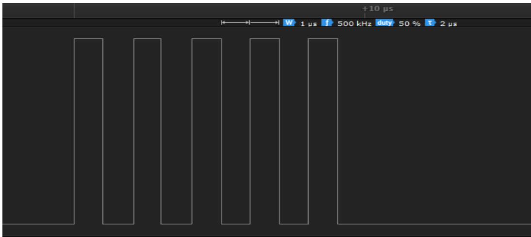
Şekil 4.4: 500KHz'de 5 adet puls verilmesi.
