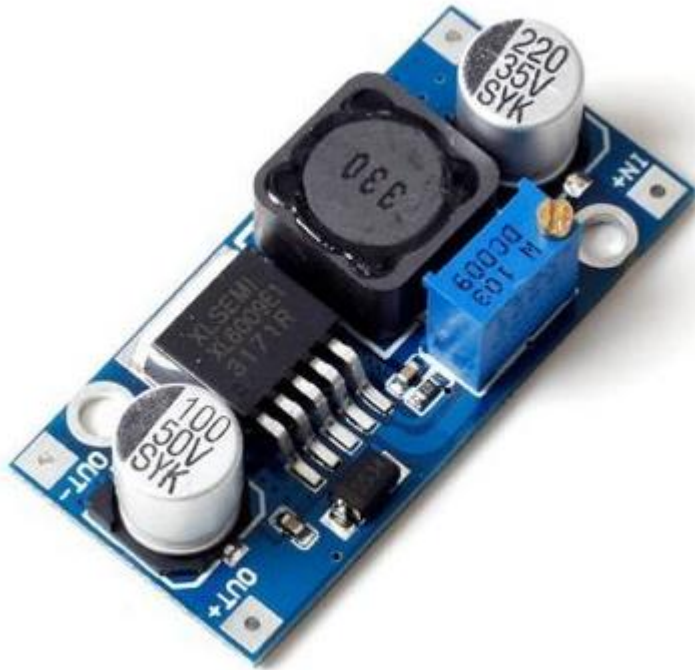
Şekil 3.2: Giriş beslemesinde gerilim arttırımını sağlama SMPS modülü.
