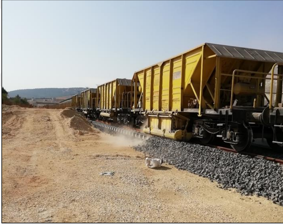
Şekil 2.3. Balast serme vagonu (LDH 125-411).
