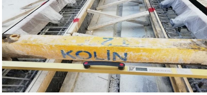
Şekil 2.10. Ekartman ölçer aleti.
