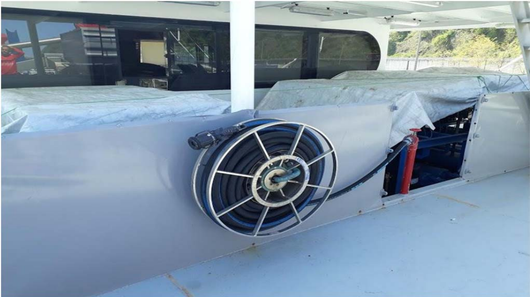
Şekil 4.10.2. Yangın hidrat sistemi
