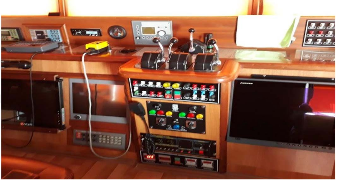
Şekil 4.8.1. Bir gemideki telsiz ve telefon haberleşme sistemi
