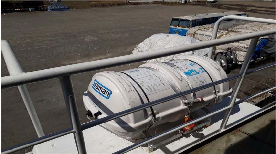
Şekil 4.4.2. Can kurtarma araçları balıkçı gemisinde yerleşimi
