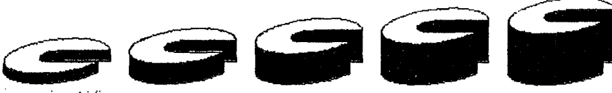
Şekil 4.2. Elektrot açıklığını ayarlamakta kullanılan 5; 10; 15; 20 ve 25 mm kalınlıklarındaki masterlar.
