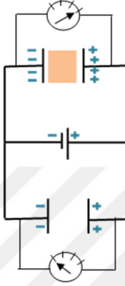
Şekil 2.2: Aynı geometrik özelliğe sahip dielektrik ve boşluk kapasitörünün aynı bataryaya bağlanması durumunda yüklenme miktarları.
