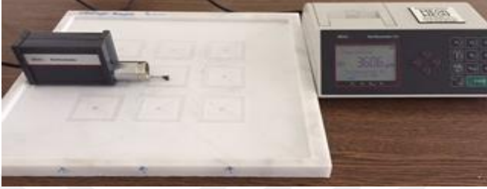
Şekil 3.31 Yüzey pürüzlülük ölçümü.
