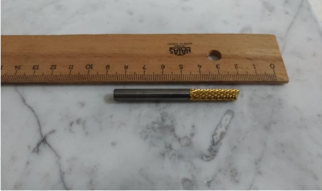
Şekil 3.6 Karbür kaplama parmak freze kesici uç.
