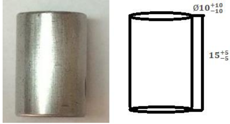
Şekil 3.1 : Elektroliz öncesi hazırlanan numune yüzey görünüşü ve geometrisi.
