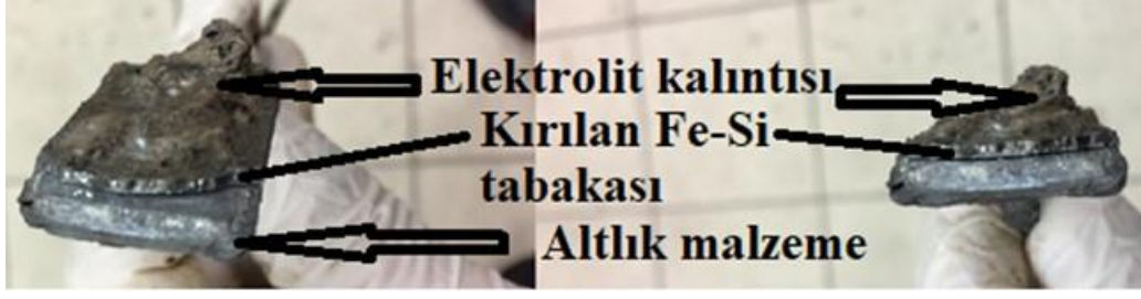
Şekil 4.12 : \sim 1000 \text{ mA/cm}^2 akım yoğunluğunda yapılan deneyde kırılan Si tabakası
