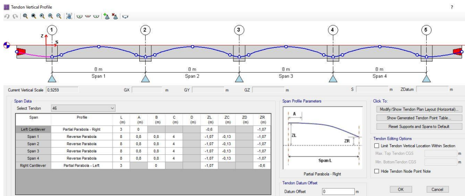
Şekil 6.14 : Y doğrultusu kablo profilinin oluşturulması
