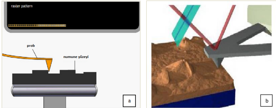
Şekil 4.3. (a) Yüzey topografyasının raster düzeninde oluşturulması, (b) manivelanın numune yüzeyini taraması
