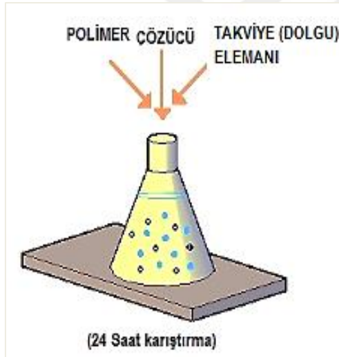
Şekil 3.1. Çözücü metoduyla nanokompozit çözeltisinin hazırlanması
