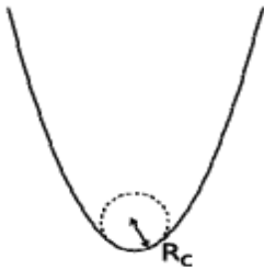
Şekil 5.4. Parabolik şekilli tipin eğrilik yarıçapı
