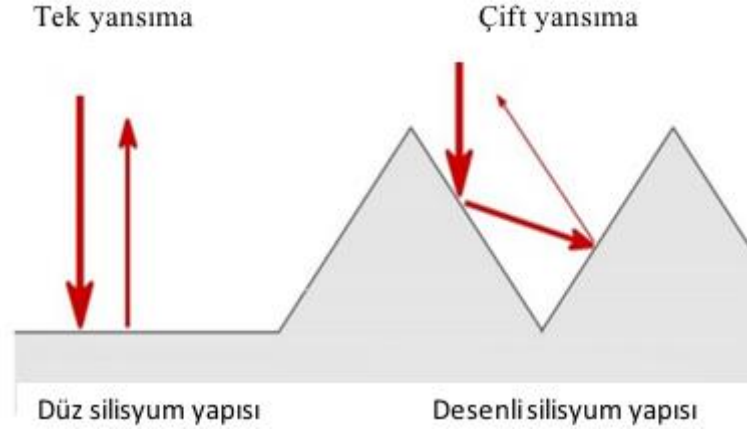
Şekil 2.4. Düz Si yüzeyine ve desenlendirilmiş Si yüzeyine düşürülen fotonların yansımaları
