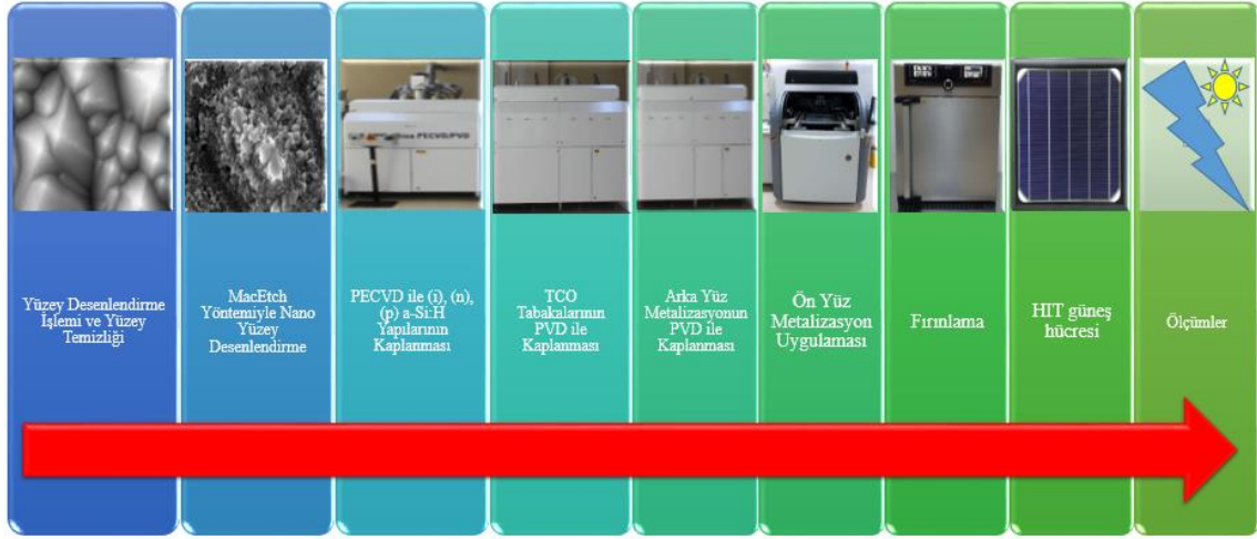
Şekil 4.10. NÖHÜNAM’da üretilen yüksek verimli HIT güneş hücrelerinin standart üretim adımları
