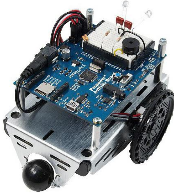
Şekil 4.81 : Mühendislik eğitimi için üretilmiş ActivityBot mobil robotu.
