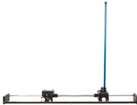
Şekil 4.29 : Quanser firmasının Ters Sarkaç deney seti.
