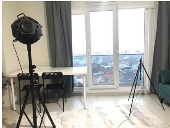
Şekil 4.3 : Örnek hoparlör ve mikrofon pozisyonu.
