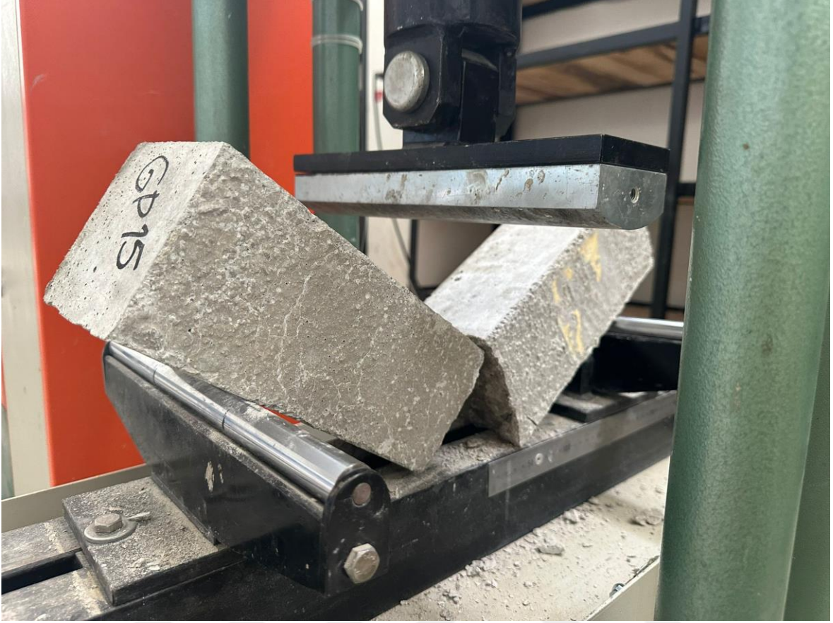
Resim 2.2.1. Üç noktalı eğilmede çekme deneyi
