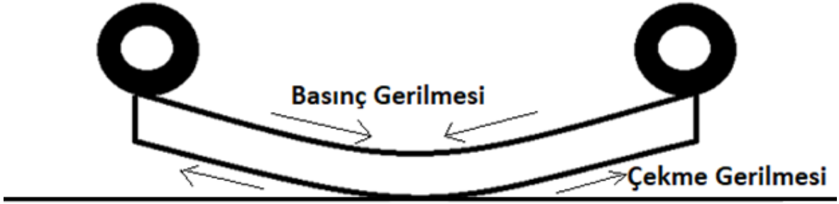
Resim 1.4.2.Gece beton yol kaplamasında oluşan gerilmeler
