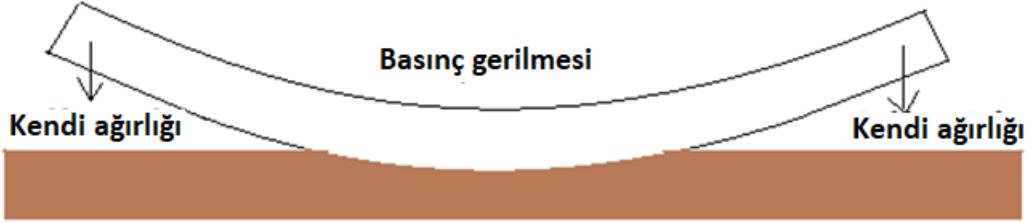
Resim 1.6.9. Gece sıcaklık farkından kıvrılan beton plak (Lederle, 2011)
