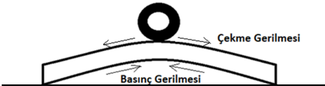
Resim 1.4.1. Gündüz beton yol kaplamasında oluşan gerilmeler
