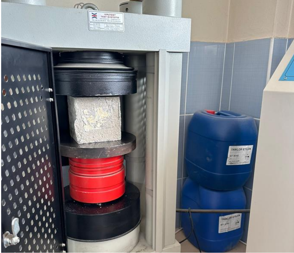
Resim 2.4.1. Tek eksenli basınç deneyi düzeneği
