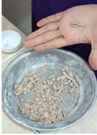
Şekil 4.17. Atık cam tozu içeren zeminlerde non-plastik davranışın gözlemlenmesi
