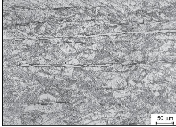
Görsel 2.5. Çökelti sertleştirilmiş paslanmaz çeliğe ait optik mikroskop mikroyapı görüntüsü [12].
