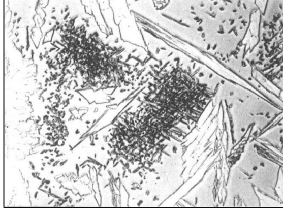
Görsel 2.11. Yapıda oluşan ikincil östenit fazı görseli [5].
