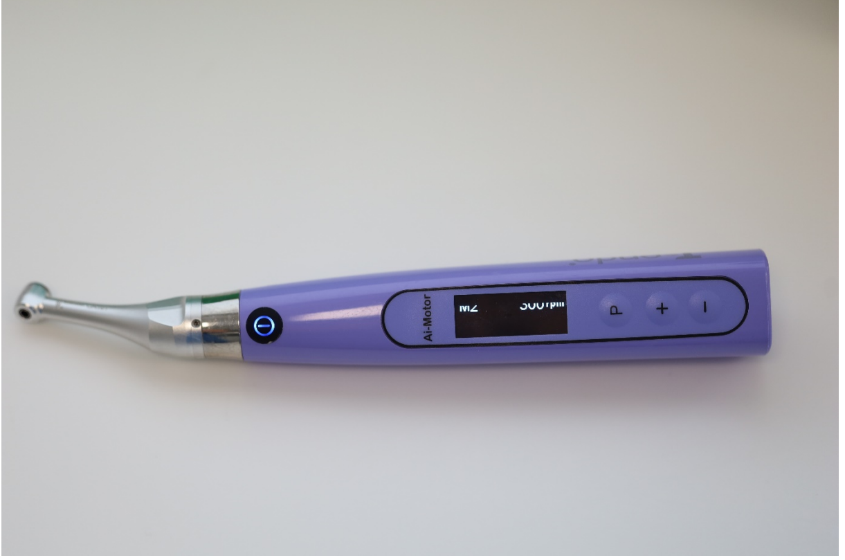
Şekil 4. Kök kanal şekillendirilmesi için kullanılan endomotor (Woodpecker AI Motor)
