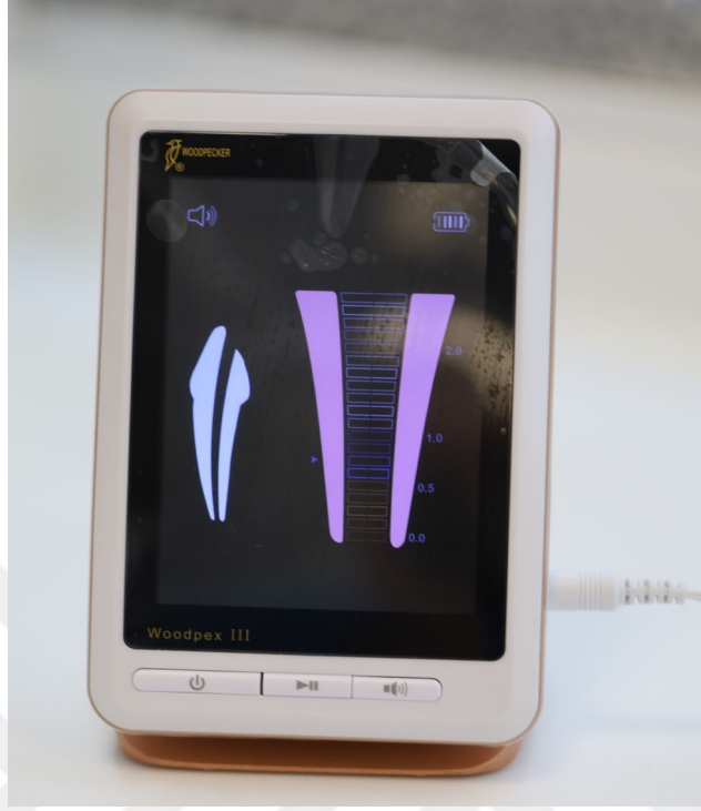
Şekil 2. Kullanılan elektronik apeks bulucu (Woodpex III)
