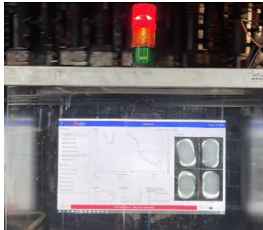
Şekil 4.21. Damla Ağırlığı Ölçüm Sistemi İkaz Lambası Görseli
