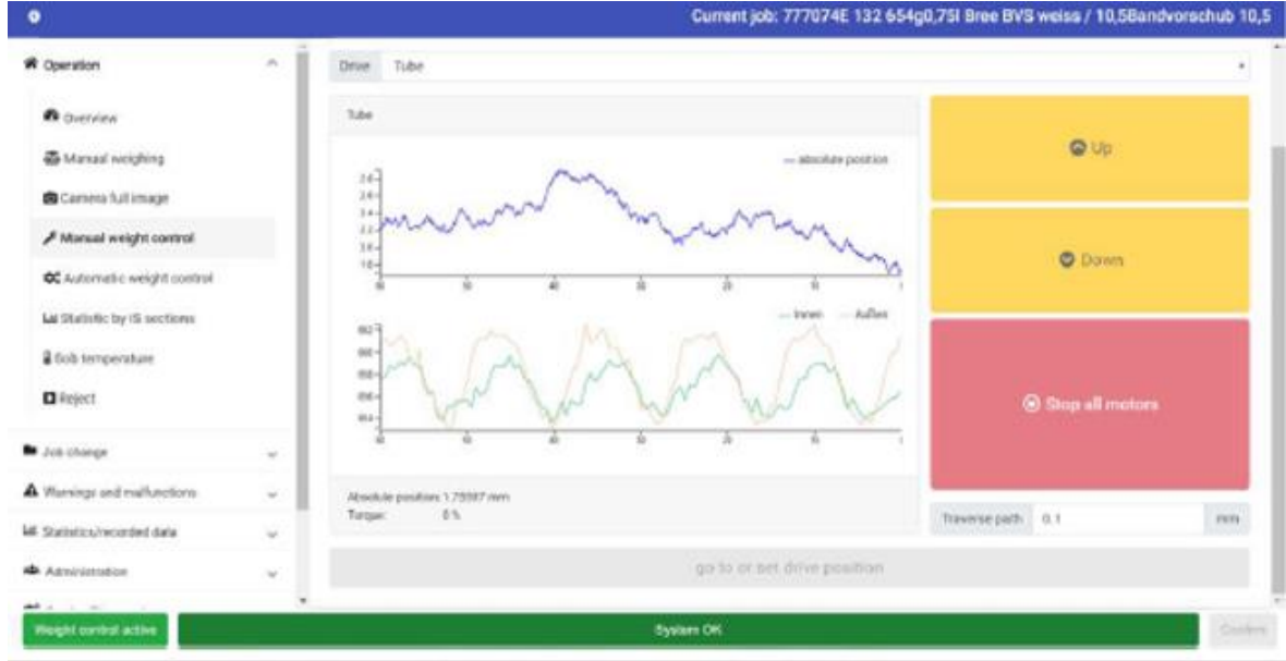
Şekil 4.17. Damla Ağırlığı Ölçüm Sistemi Manuel Kontrol Arayüzü
