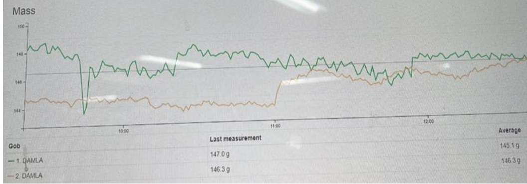
Şekil 4.25. Damla Ağırlığı Ölçüm Sistemi Damlalar Arası Ağırlık Karşılaştırma Grafığı
